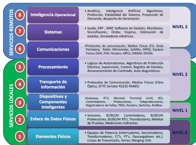
Figura 3.3 Modelo del funcionamiento desde la perspectiva de ciberseguridad
