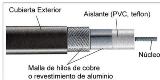
Figura 2.17: Partes de un cable coaxial
