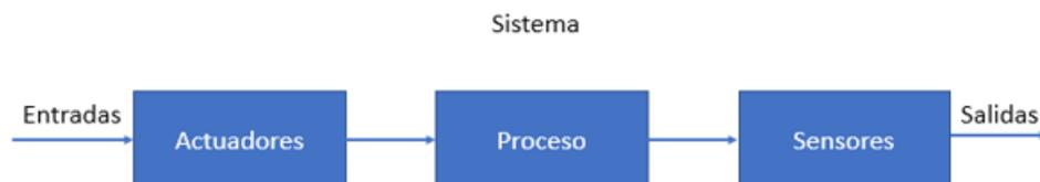
Figura 2. 2: Estructura de un sistema de control de lazo abierto.
