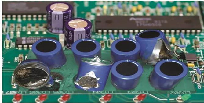
Figura 2. 13 Daños en equipos electrónicos sensibles
