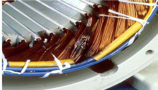
Figura 2. 11 Rotura en el devanado de un motor
