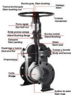
**Figura 19** Válvula de Compuerta.
