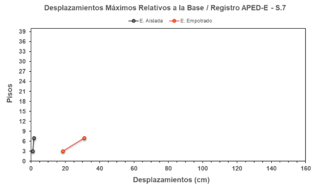
Ilustración 27. Desplazamientos Máximos Relativos a la Base de Estructura Aislada y Estructura Empotrada de 7 Pisos para Registro APED-E.
