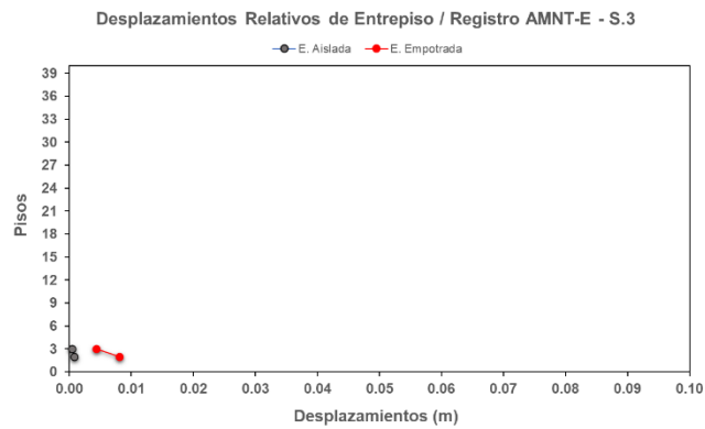
Ilustración 102. Desplazamientos Relativos de Entrepiso de Estructura Aislada y Estructura Empotrada - S.3 para el registro sísmico AMNT-E.
