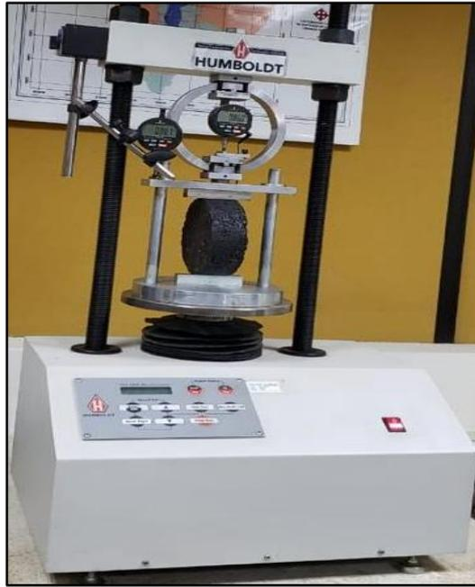
**Figura 19.** Máquina de tracción indirecta utilizada para la prueba IDEAL
