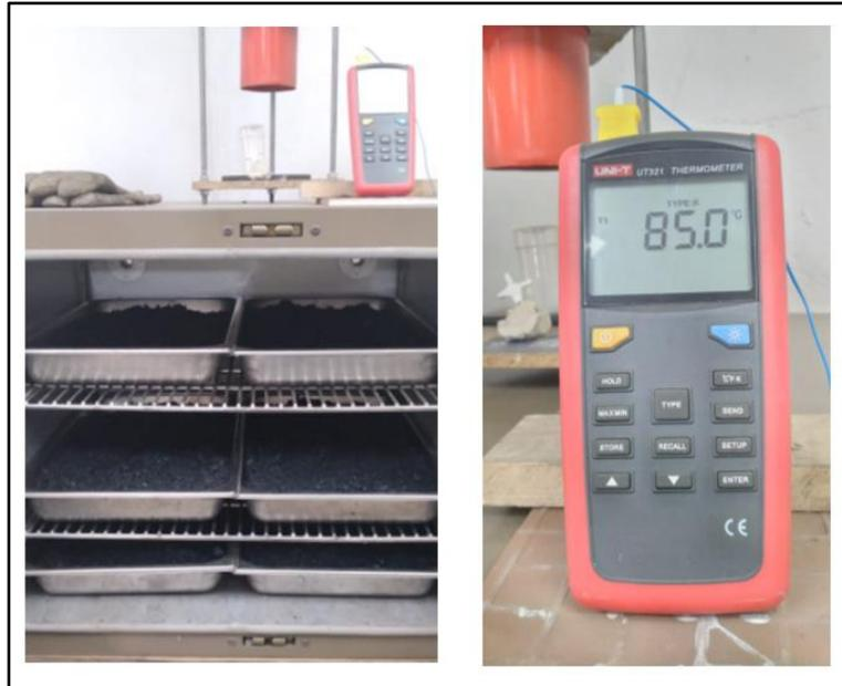
**Figura 32.** Bandejas con mezclas para su envejecimiento
