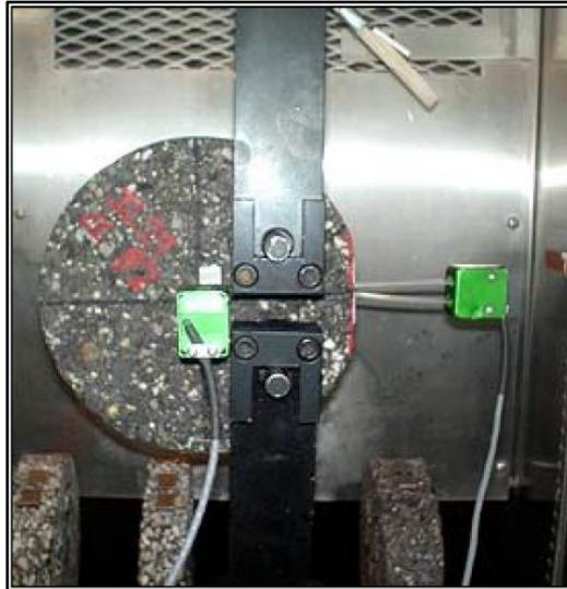
**Figura 14.** Prueba de tracción en disco barrenado.
