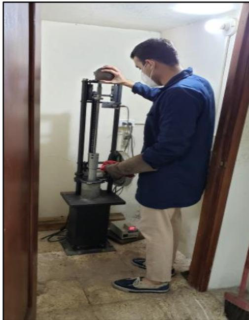
**Figura 31.** Compactador automático
