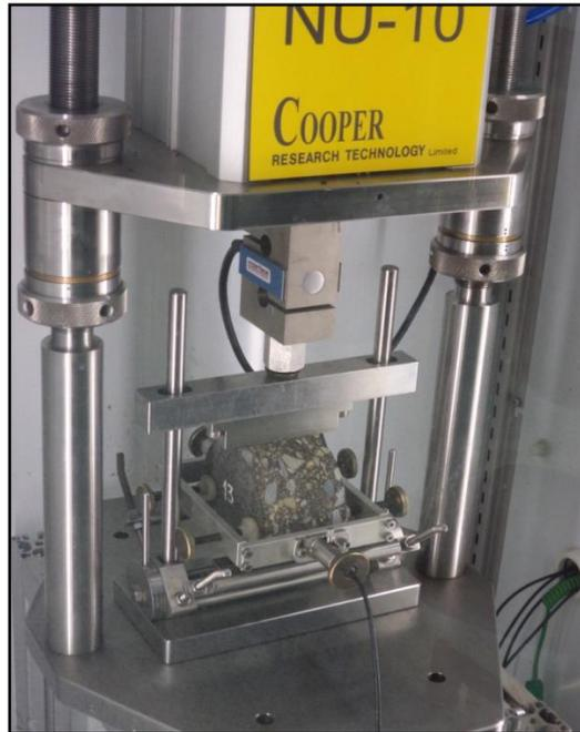
**Figura 44.** Equipo NAT en una prueba de módulo de rigidez
