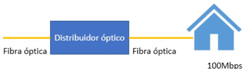
Figura 2. 4: Estructura de una red FTTH.
