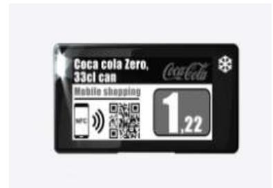
la misma que no posee ni LED ni Easylock, ya que consta con una pantalla gráfica de E Ink. En cuanto a su resolución, cuenta con 296 x 152 píxeles, y una densidad de 125 DPI, por último, este producto tiene una temperatura de funcionamiento de : -25° C a 30°C/ -13 °F a 86 °F (Ses Imagotag, 2021).
