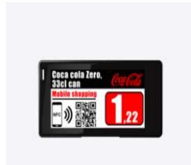
de E Ink; se establece que este dispositivo tiene una temperatura de funcionamiento de : 10 a 40°C/ 50 A 104° F (Ses Imagotag, 2021).
