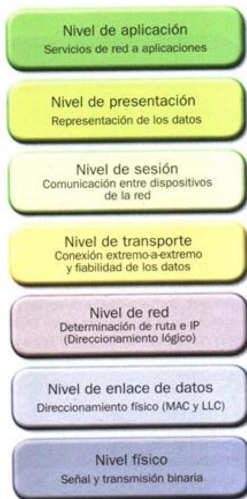
Figura 3. 3: Modelo ISO/OSI de comunicación de capas o niveles.
