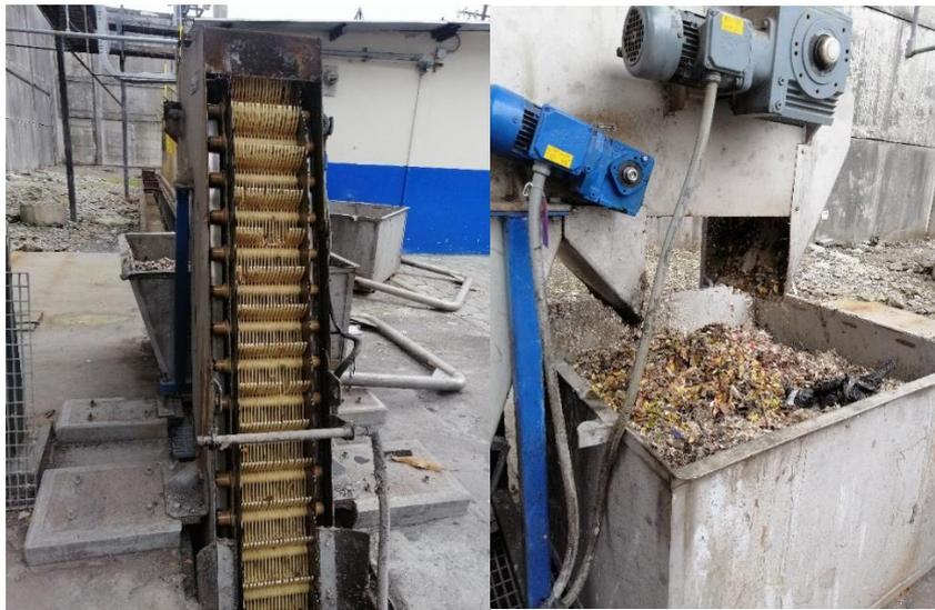
El material ya separado de elementos contaminantes de mayor tamaño continua su recorrido por el siguiente sistema que consta de un tornillo ascendente con desplazamiento positivo conectado a un motor el cual separa de partículas de menor tamaño que el anterior proceso no se logró dividir del agua y residuos, esta maquinaria es el más antigua utilizado en las plantas de papel en disgregar solidos como se aprecia en la figura.
