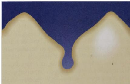
FIGURA N°26. Fisura en forma de gota. <sup>41</sup>
