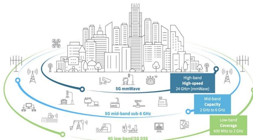
Figura 2. 7: Bandas de frecuencia en el núcleo de las redes 5G
