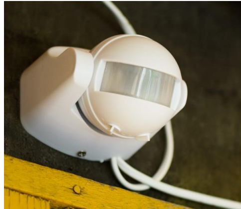
Figura 2.26: Ejemplo de sensor de movimiento. Fuente: (Ledovet, 2018)
