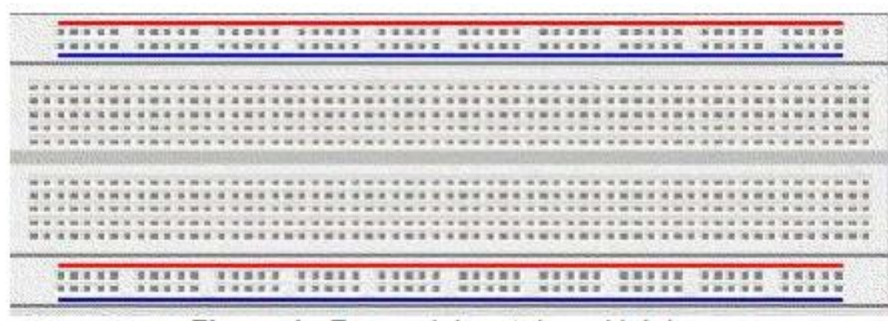
Figura 2.28: Forma básica del Protoboard. Fuente: (Guadamuz, 2016)
