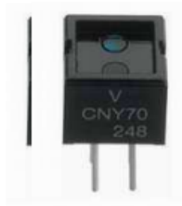
Figura 2.24: Representación de un sensor reflectivo. Fuente: (Gonzalez, 2012)
