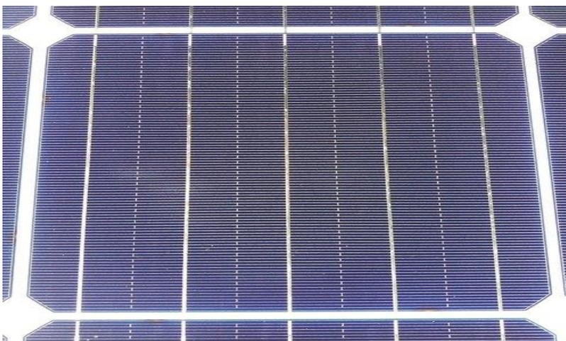
*Nota.* Célula solar monocristalina típica con 5 barras colectoras. Adaptado de construcción de paneles solares. Clean energy reviews, por (Svarc, 2020).
