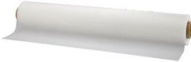
*Nota.* Capas de película EVA (etilenvinilacetato) es una capa (plástica) de polímero. Adaptado de construcción de paneles solares. Clean energy reviews, por (Svarc, 2020).
