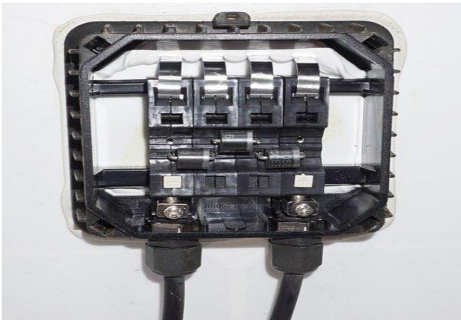
*Nota.* Dentro de una caja de conexiones de un panel solar típico de 60 celdas que muestra los 3 diodos de derivación. Adaptado de construcción de paneles solares. Clean energy reviews, por (Svarc, 2020).
