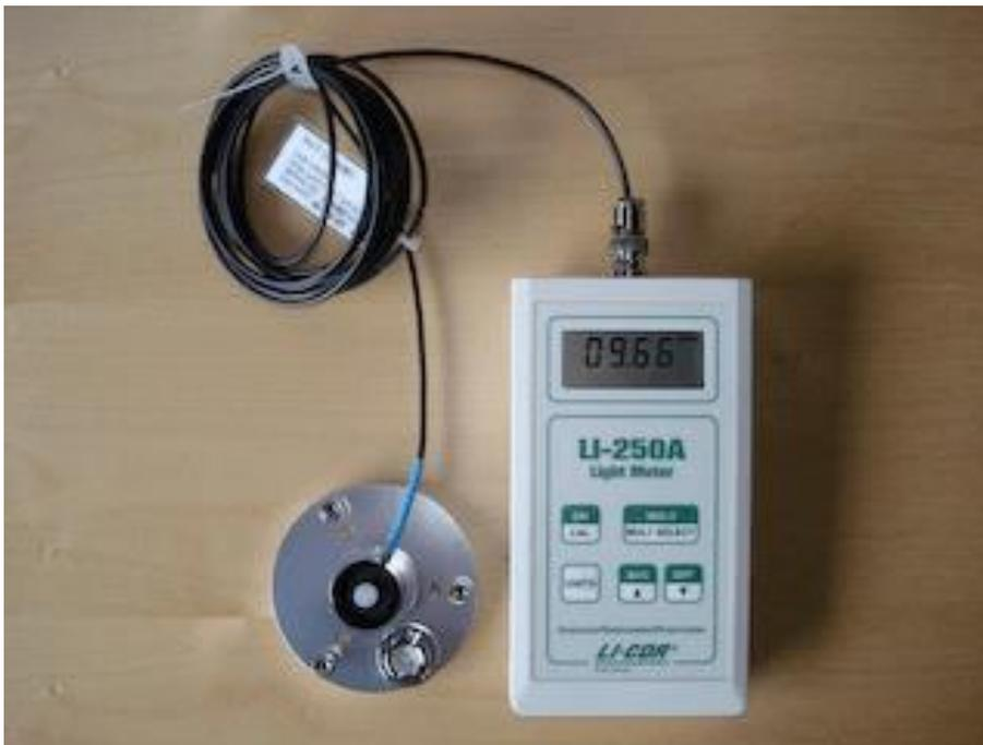
*Nota.* Sensor cuántico conectado a un medidor de luz. Adaptado de Información de instrumentos de radiación solar. Globalspec, por (Globalspec, 2021).
