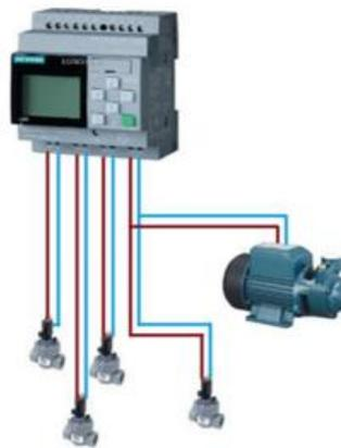
Figura 2. 12 salidas de logo V8 conectadas a dispositivos de campo
