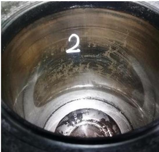
*Nota:* La ilustración muestra manchas de agua y señales de corrosión en la camisa del cilindro #2. Este daño se debe al ingreso de agua de mar proveniente del posenfriador del aire de admisión.
