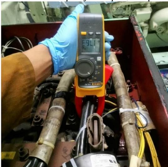
*Nota:* La ilustración muestra el uso de una pinza amperimétrica marca Fluke, modelo 376FC. Se mide la intensidad de corriente eléctrica en los cables de salida o poder de un generador correspondiente a un grupo electrógeno Caterpillar.
