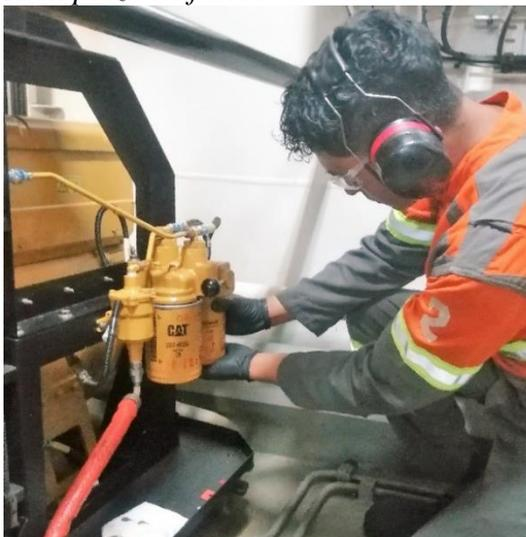
*Nota:* La ilustración muestra el reemplazo de los filtros de combustible del motor de combustión.
