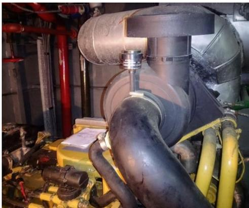
*Nota:* La ilustración muestra la ubicación del indicador de restricción del filtro de aire. La base del indicador es parte de la caja de filtro de aire y está ubicado después del filtro, a la entrada del turbocompresor.
