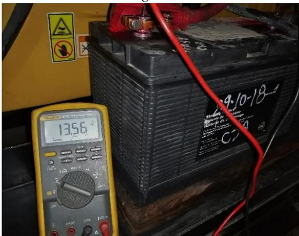
*Nota:* La ilustración muestra el uso de un multímetro digital marca Fluke, modelo 87V. Se mide el nivel de voltaje de una batería de un grupo electrógeno; conectada a un mantenedor de carga. Es importante revisar el nivel de electrolito y la concentración de la solución con un refractómetro.
