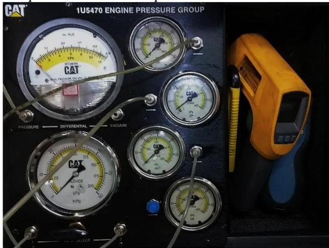
*Nota:* La ilustración muestra el uso del grupo de manómetros para evaluación de motores de combustión. Este grupo es de marca Caterpillar y permite medir diferentes parámetros como: Presión de aceite, presión del sistema de enfriamiento, presión de combustible, presión del aire reforzado, etc.
