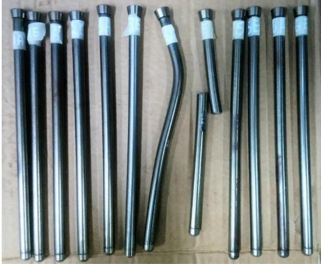
*Nota:* La ilustración muestra 12 válvulas de empuje de un motor C9 de aplicación marina. Las varillas correspondientes al cilindro 4 presentan daño estructural como resultado de una calibración de válvulas incorrecta.
