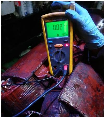
*Nota:* La ilustración muestra el uso de un megóhmetro marca Fluke. Se mide la resistencia del aislamiento con respecto a tierra del rotor principal, registrando  $0.02M\Omega$ . Adicionalmente, se observa expansión y desprendimiento del barniz en las esquinas de los polos del rotor principal.
