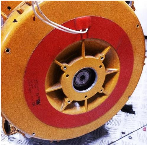
*Nota:* La ilustración muestra la ubicación de la faja térmica en un grupo electrógeno C4.4. La faja térmica está situada en la caja de alojamiento del cojinete y para su acceso se ha realizado el desmontaje de la tapa posterior.
