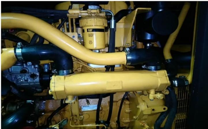
*Nota:* La ilustración muestra la ubicación del intercambiador de calor de tipo tubular. Las tuberías conectadas en la parte superior son del circuito de refrigerante del motor y las que están ubicadas a un costado, corresponden al sistema de agua de mar.
