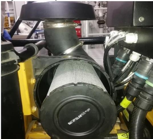
*Nota:* La ilustración muestra la ubicación del filtro de aire en un grupo electrógeno C4.4 Caterpillar. Se ha desmontado la tapa de la caja de filtro de aire para visualizar el filtro de aire primario. La caja de filtro de aire está ubicada detrás del motor de combustión interna, en la parte superior de la rejilla del ventilador del generador de energía.
