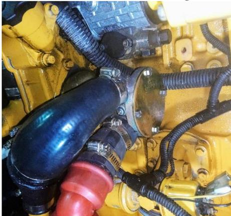
*Nota:* La ilustración muestra la bomba de agua de mar instalada en el motor. Se puede observar la tapa de la bomba, sujeta con 4 pernos. La bomba está construida de un material resistente a la corrosión.
