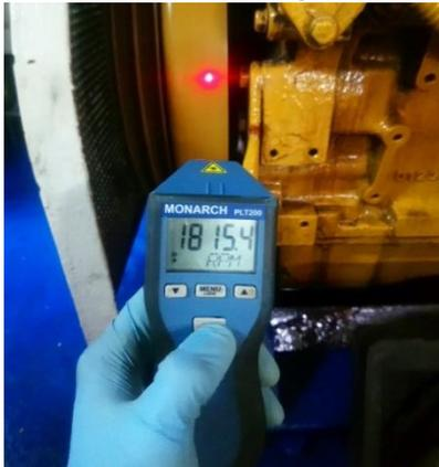
*Nota:* La ilustración muestra el uso de un tacómetro digital marca Monarch, modelo PLT200. Se registra un valor de 1815 rpm, medido en el amortiguador de vibraciones del motor de combustión interna. El amortiguador de vibraciones está acoplado directamente al cigüeñal del motor.
