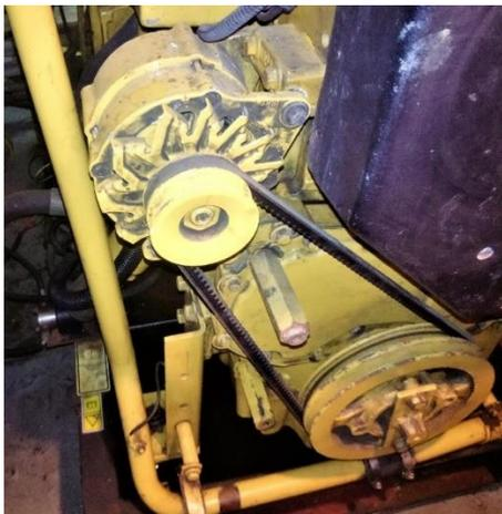
*Nota:* La ilustración muestra la parte delantera de un motor C4.4. Se puede observar la banda del alternador instalada en el motor.
