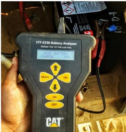
*Nota:* La ilustración muestra el uso del analizador de carga de baterías. Esta herramienta indica “Good battery” cuando una batería está en buen estado o “Bad battery” cuando se necesita reemplazo. Para ejecutar el análisis, es necesario disponer de la capacidad de la batería en CA o CCA.
