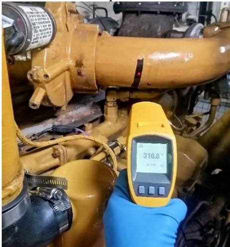
*Nota:* La ilustración muestra el uso de un termómetro infrarrojo marca Fluke, modelo 568. Se mide la temperatura del conducto de aire reforzado por el turbocargador en un motor de combustión a diésel de marca Caterpillar. Se utiliza una cinta negra en el área a medir para mejorar la precisión de la lectura por motivos de la emisividad de la superficie del material. (UNI - T, 2022, sec. 8)
