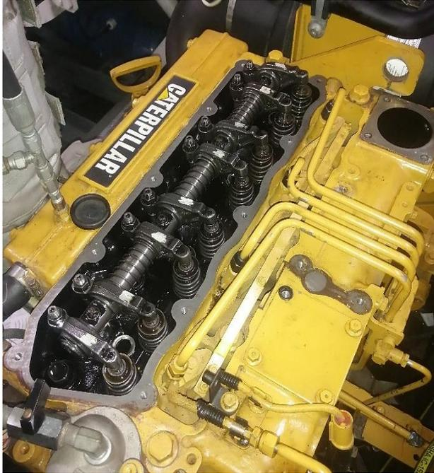
*Nota:* La ilustración muestra la vista superior de un motor C4.4. Se ha desmontado la tapa del mecanismo de válvulas para verificar las holguras de las válvulas de admisión y escape del motor. Se debe reemplazar el empaque de la tapa cada vez que se desmonte para evitar fugas de aceite en el motor.
