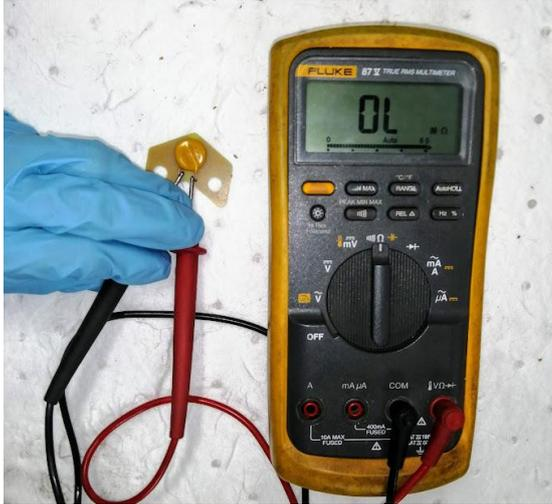
*Nota:* La ilustración muestra la medición de resistencia del varistor de un grupo electrógeno C4.4 Caterpillar. Esta es una de las pruebas que se le realiza a este componente semiconductor.
