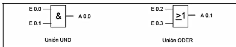
Fig. 2.7.- Diagrama de bloques FUP
