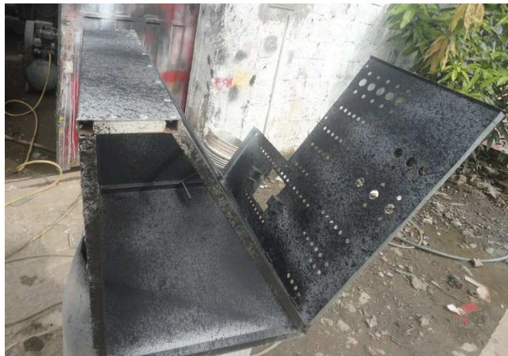
Fig. 4.12.- Primer recubrimiento.
