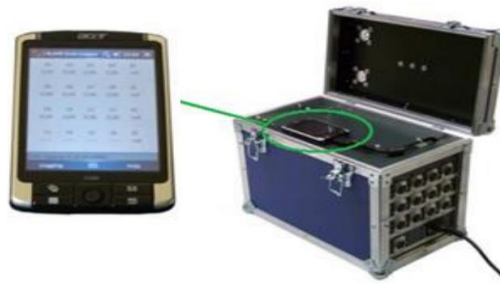
Figura 3. 1 Caja de medición con Data Logger BOGE Fuente. El autor
