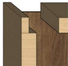
Ensamble a media madera, reforzado con colas de fijación.
