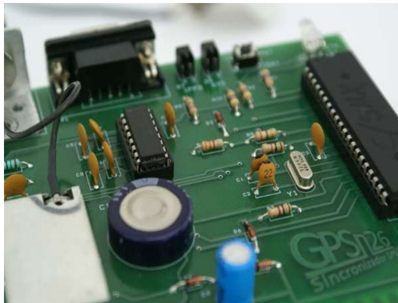
Figura 2.5: Componentes Thru-Hole en una plataforma base. Fuente: www.traffitec.cl
