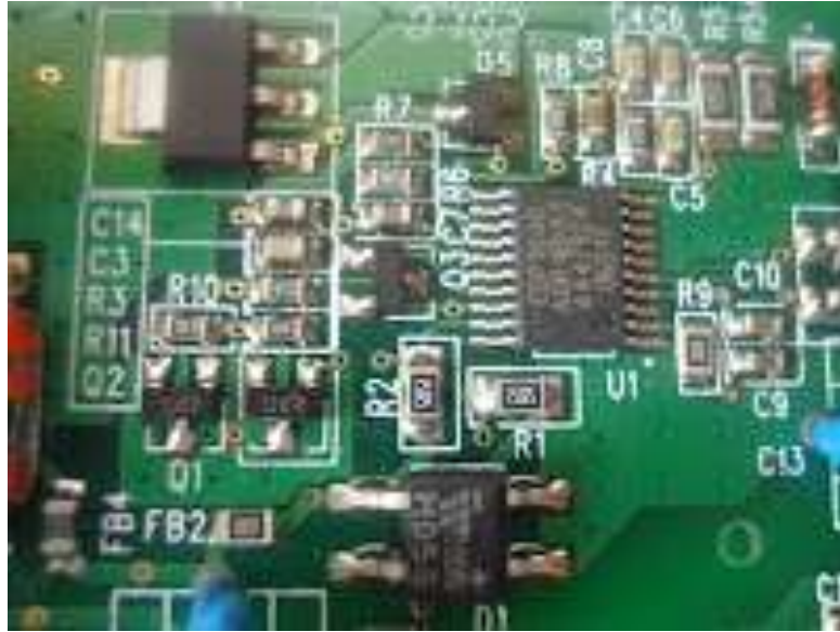
Figura 2.7: Componentes SMD/SMT en una plataforma base. Fuente: Alex Méndez
