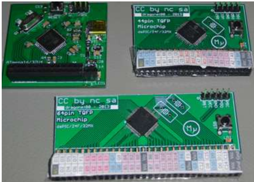
Figura 2.15: Apilamientos de cabeceras de una plataforma base. Fuente: www.pcb.electrosoft.cl
