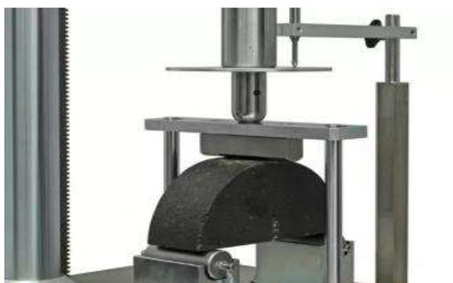
**Figura 11.** Configuración para la prueba SCB.
