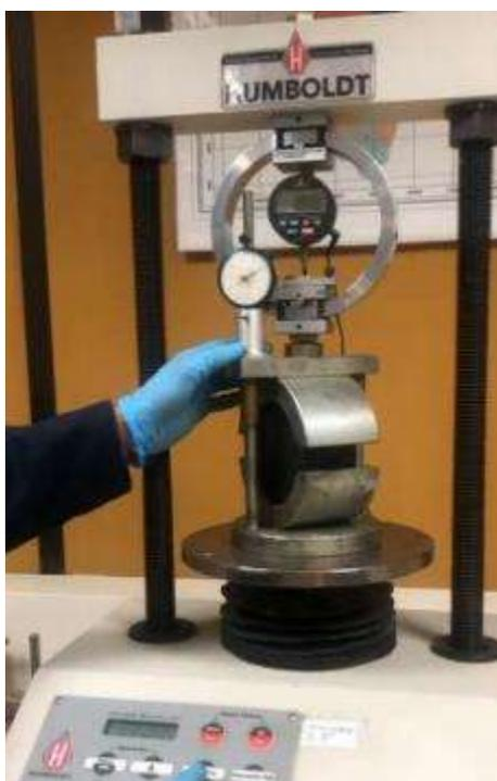
**Figura 2.** Ensayo de estabilidad Marshall.
