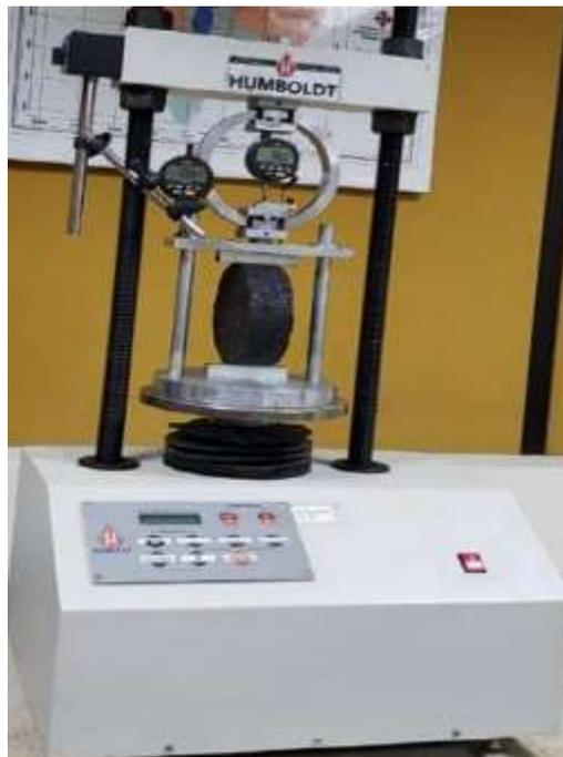
**Figura 12.** Prensa utilizada para la prueba IDEAL.
