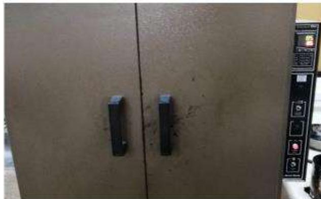
**Figura 24.** Horno utilizado para envejecimiento de las briquetas.
