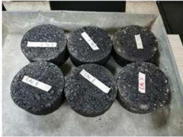
**Figura 23.** Briquetas compactadas de la Planta 2 (agregados calizos).
