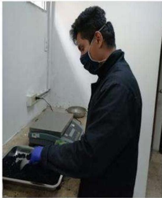
**Figura 22.** Pesado de muestra para elaboración de briquetas.
