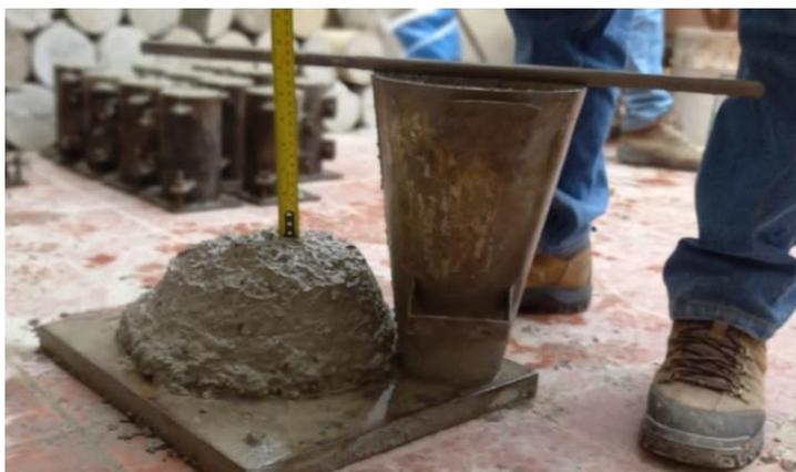
**Ilustración 12. Instrumentación para ensayo del Cono de Abrams. Fuente: Elaboración Propia**
