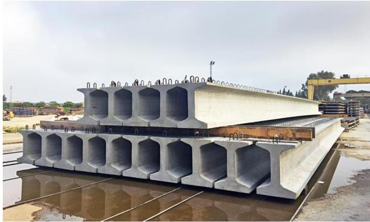
*Nota: Bulb T prefabricados de hormigón pretensado. Fuente: (Pacadar, 2018)*
