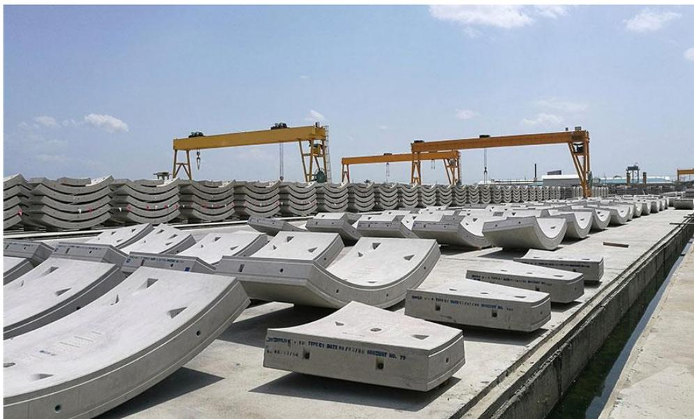
*Nota: Producción en patios de estructuras prefabricadas. Fuente: (Prefabricados de Concreto: Guía de Usos y Ventajas I PSI Concreto, 2020)*
