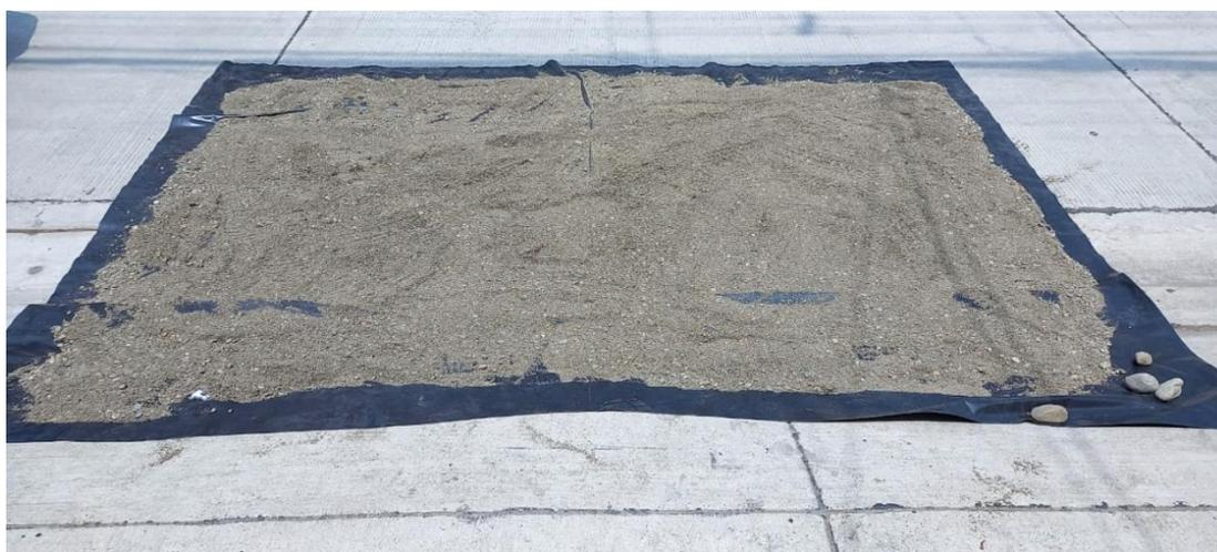
Ilustración 22. Proceso de secado natural del agregado fino
