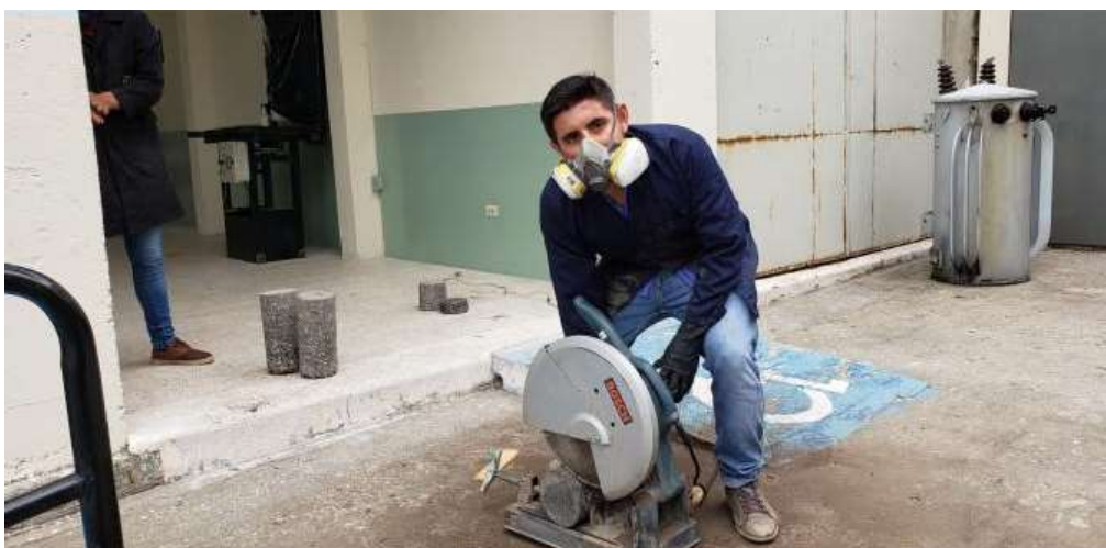
Figura 17. Extracción de núcleos en el Tramo 1.
