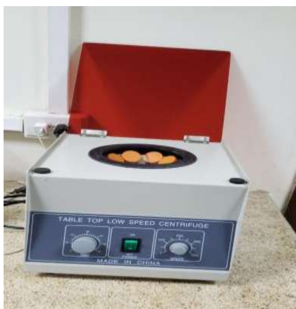
Figura 22. Centrífuga empleada para extracción de sedimentos
