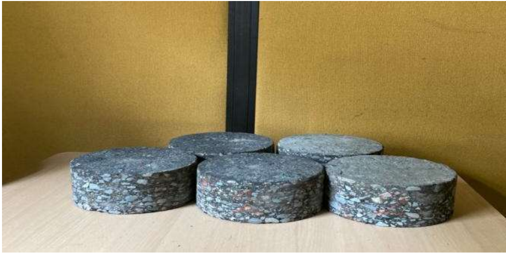
Figura 19. Núcleos cortados para extracción de asfalto.
