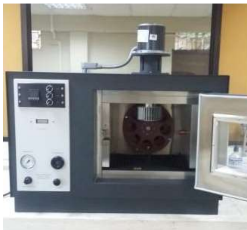
Figura 12. Horno para prueba de película delgada rotatoria.
