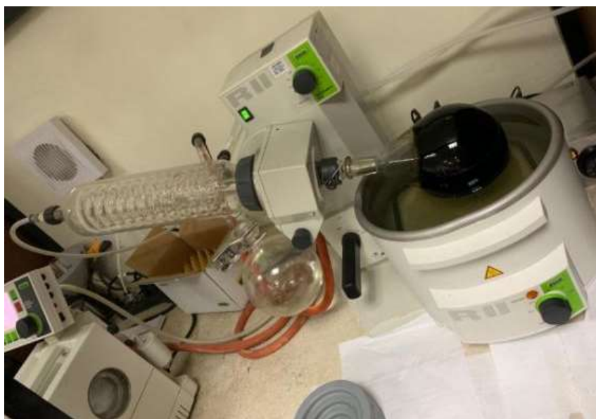
Figura 26. Equipo Rotavapor empleado en funcionamiento
