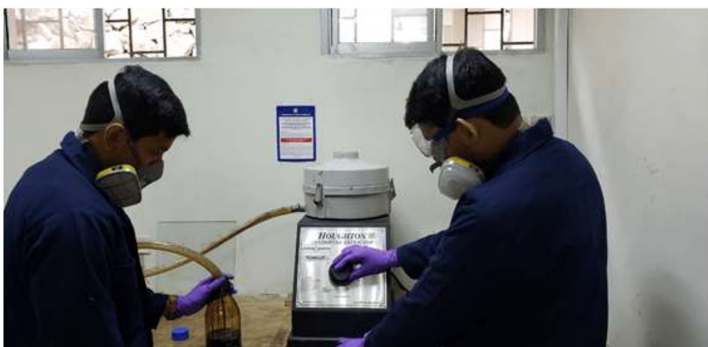
Figura 21. Extracción inicial del asfalto de las mezclas con solvente
