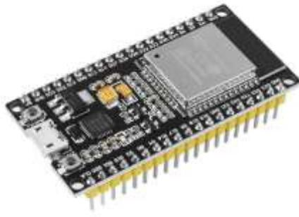
*Figura 12.* Placa ESP32. *Nota* Tomado de: CDMX Electrónica
