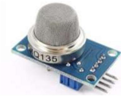
Figura 5. Sensor MQ135. Nota Tomado de: MarkerElectronico
