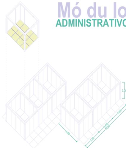
Cada módulo administrativo se configura de 3 módulos longitudinales y 4 módulos transversales permitiendo una agrupación compuesta de 9 módulos longitudinales, manteniendo 4 módulos transversales.
