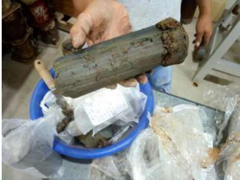
*Ilustración 23. Muestra extraída de tubo Shelby previo al corte.*
