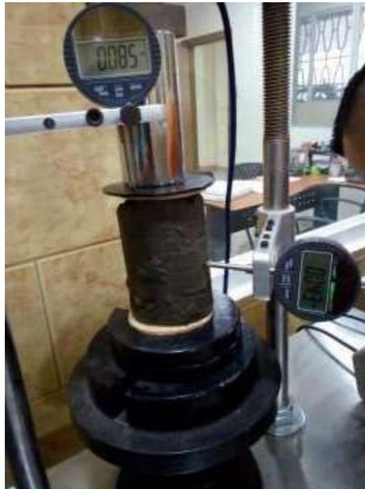
*Ilustración 29. Monitoreo de deformaciones durante ensayo.*
