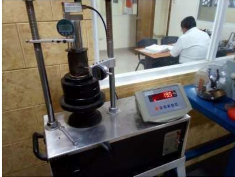
*Ilustración 24. Equipo de ensayo de compresión simple.*
