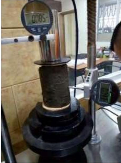
*Ilustración 30. Ubicacion de diales en punto longitudinal y transversal*
