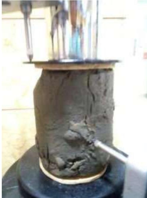
Ilustración 34. Falla de la muestra 1.
