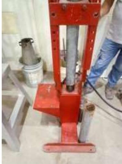
*Ilustración 21. Equipo de extracción de muestra*
