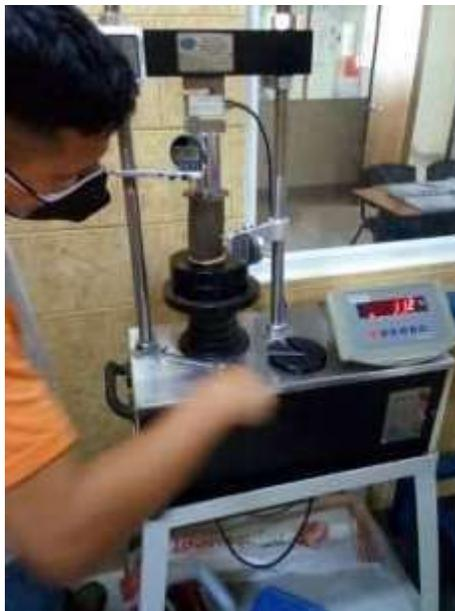
*Ilustración 26. Aplicación de carga y descarga de manera manual.*
