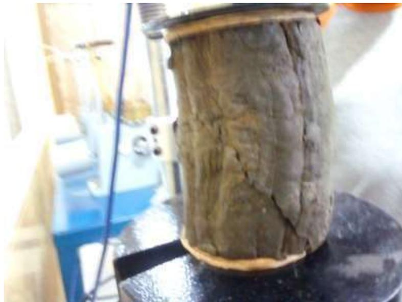
Ilustración 40. Muestra con fallo luego de la compresión
