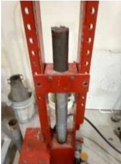
*Ilustración 22. Extracción de muestra de arcilla.*
