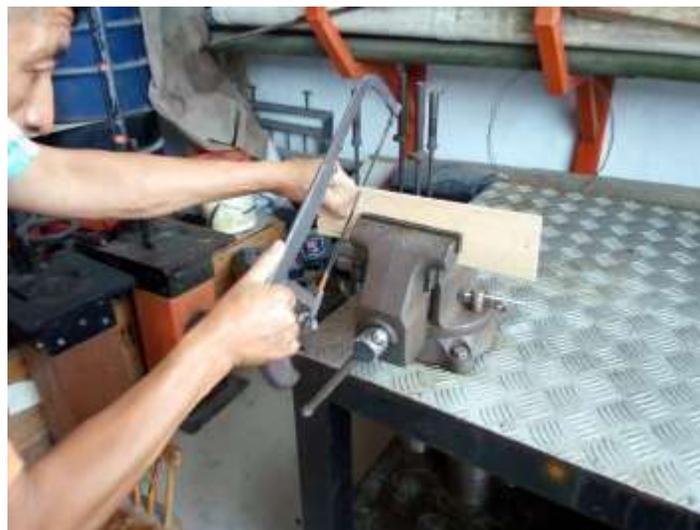
*Ilustración 27. Corte y preparación de placas de madera para ensayo.*
