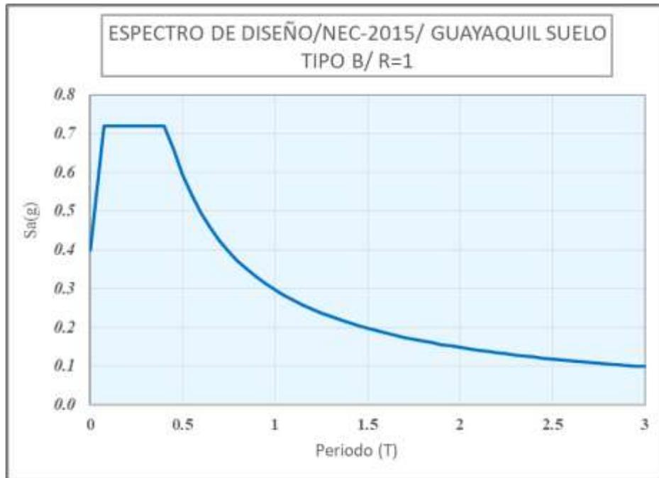
Ilustración 43. Espectro elástico de respuesta sísmica para un suelo tipo B en la ciudad de Guayaquil según el código (NEC, 2015)
