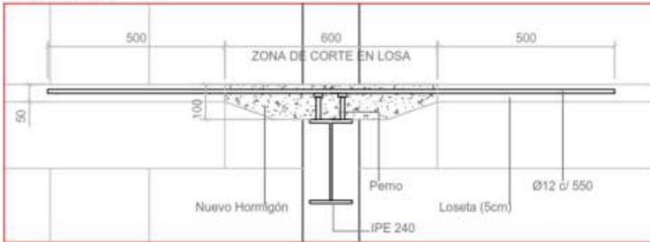
**SECCIÓN DE CONEXIÓN DE LOSA EXISTENTE CON SISTEMA DE REFUERZO**
