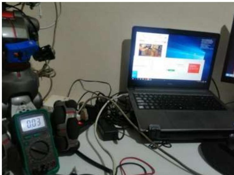
Figura 4-12 Medición de corriente utilizando un multímetro al ejecutar los servicios de la nube
