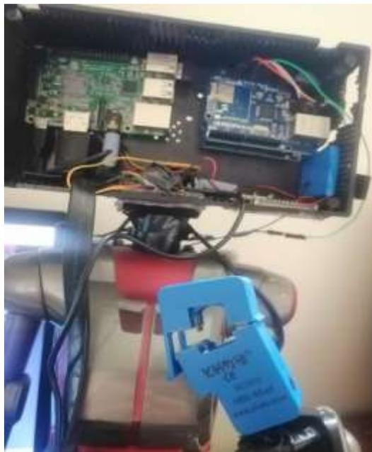
Figura 3-6 Conexiones internas del robot medidor de consumo
