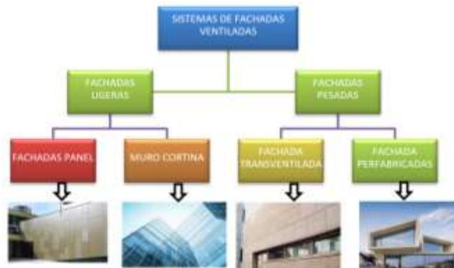
Figura 2-6: Sistemas de fachadas ventiladas
