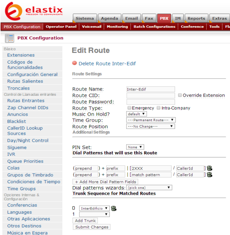
Figura 5.30 – Configuración de ruta para interconexión entre PBX – Matriz Fuente: [el Autor]
