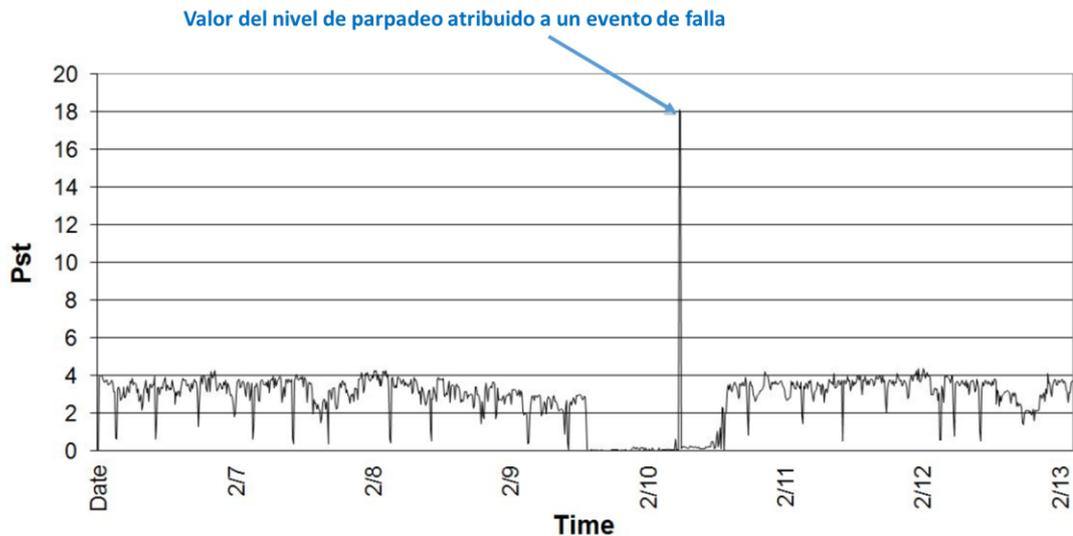
Figura 1.7 Parpadeo (flicker) producido por una falla en la carga (*IEEE Recommended Practice for the Analysis of Fluctuating Installations on Power Systems, 2015, pág. 19*).
