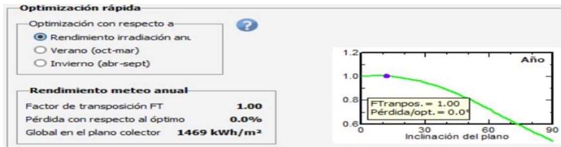
Figura 4. 6. Angulo de inclinación en módulos fotovoltaicos
