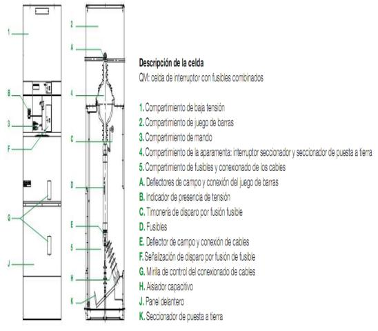
Figura 2. Celdas de Media Tensión Fuente catalogo ABB
