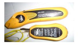
Figura 11. Seguidor de líneas eléctricas
