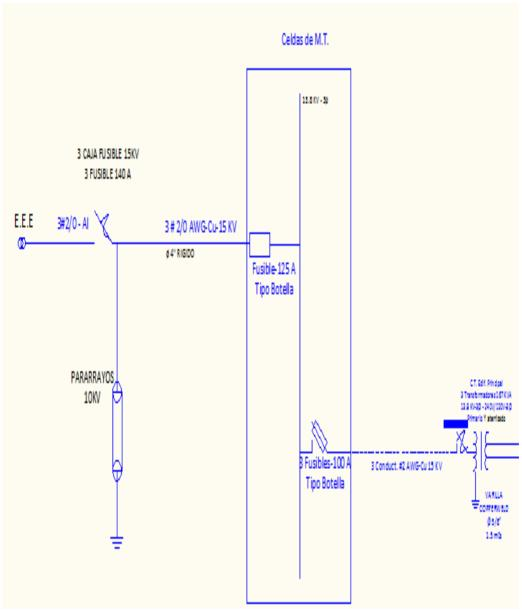
Gráfico 38. Diagrama Unifilar de Media Tensión 6.2. DIAGRAMA UNIFILAR DE BAJA TENSIÓN
