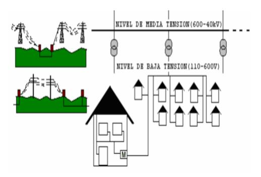
Figura 1. Ilustración de los niveles de voltaje de media y baja tensión
