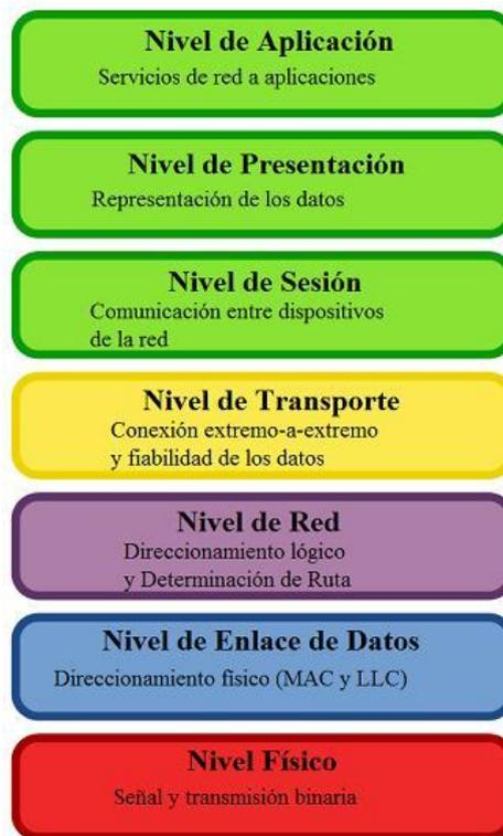
Figura 3.9 Capas del modelo OSI
