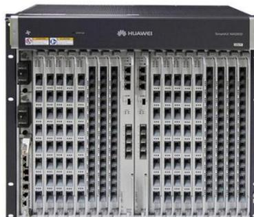
Figura 2.13: Modelo de OLT Huawei Smart AX MA5800
