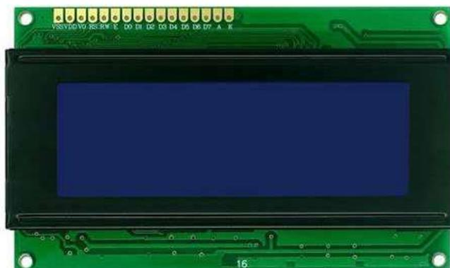
Figura 32. Pantalla Lcd 4x20 (Gallardo, 2014).
