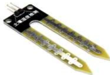
**Figura 30.** Sensor de humedad Arduino (Aldea, 2016).
