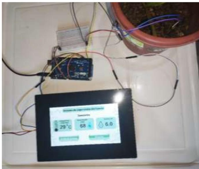
Figura 38: Implementación control de humedad
