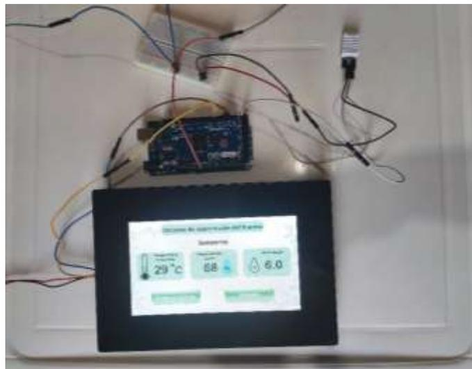
Figura 36: Implementación control de temperatura
