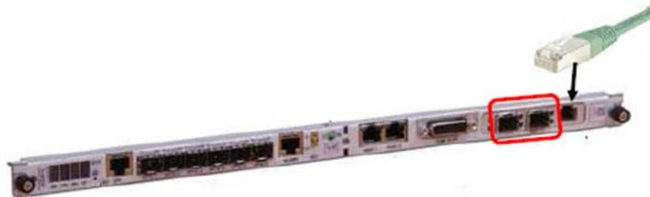
Figura 3. 17: Conexión RJ45 para la red de retorno.
