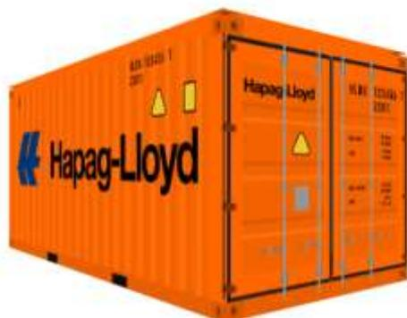
*Nota.* Esta imagen muestra el contenedor dry de 20 pies, que tiene una carga máxima de 25 toneladas y es de la naviera Hapag-Lloyd. Tomada de (Hapag-Lloyd, 2022).
