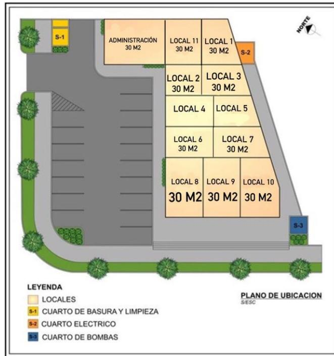
La plaza comercial contará con 400m<sup>2</sup> de construcción, en la cual tendrá: una oficina administrativa, 23 locales distribuidos en dos plantas, un parqueadero con capacidad para 10 carros, un cuarto eléctrico con generador de energía, un cuarto de bombas con tanque de agua capacidad de 1 tonelada m<sup>3</sup>, un cuarto de limpieza y oficina. Además, contará con circuito cerrado de 8 cámaras y una garita de seguridad.
