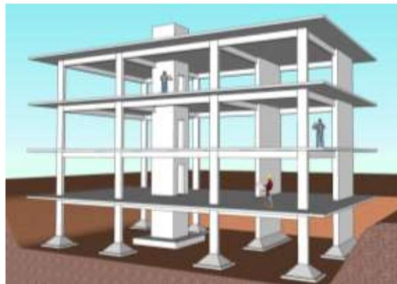
Figura 12. Tipo de construcción: Pórtico de hormigón armado con muros estructurales (C2)
