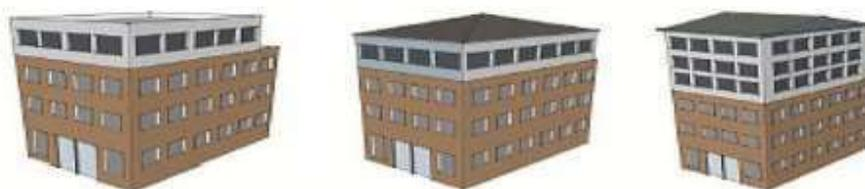
Figura 29. Irregularidad vertical: Irregularidad por adicionamiento
