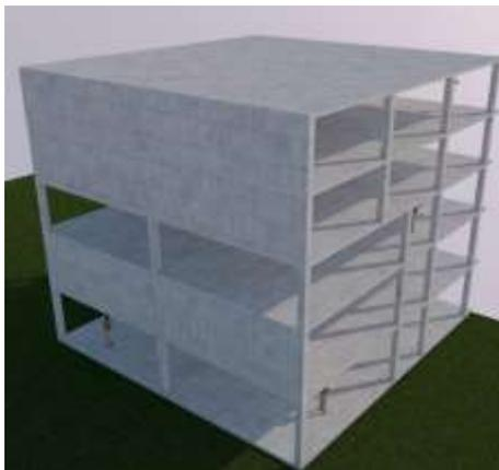
Figura 26. Irregularidad vertical: Irregularidad por ejes verticales discontinuos
