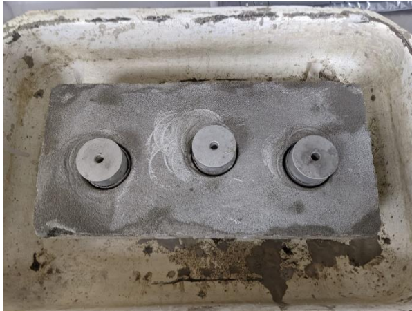
Figura 7 Discos de ensayo pegados a bloques por medio del pegamento epóxico
