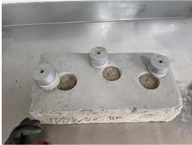
Figura 10 Muestras de bloque extraídas por medio del ensayo de adherencia
