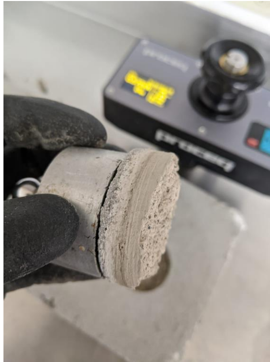
Figura 11 Muestra extraída por ensayo de adherencia
