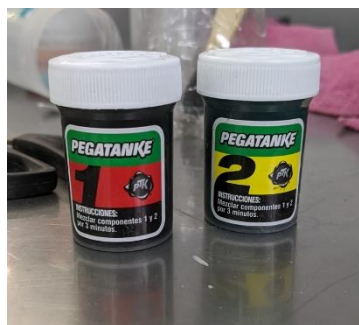
Figura 6 Epóxico utilizado para pegar los discos de ensayo al enlucido del bloque
