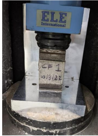
Figura 8 Ensayo de compresión a cubo de mortero
