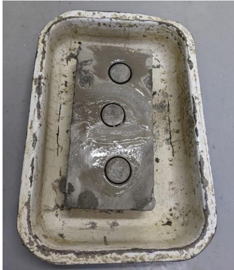
Figura 5 Perforaciones en bloques para ensayo de adherencia
