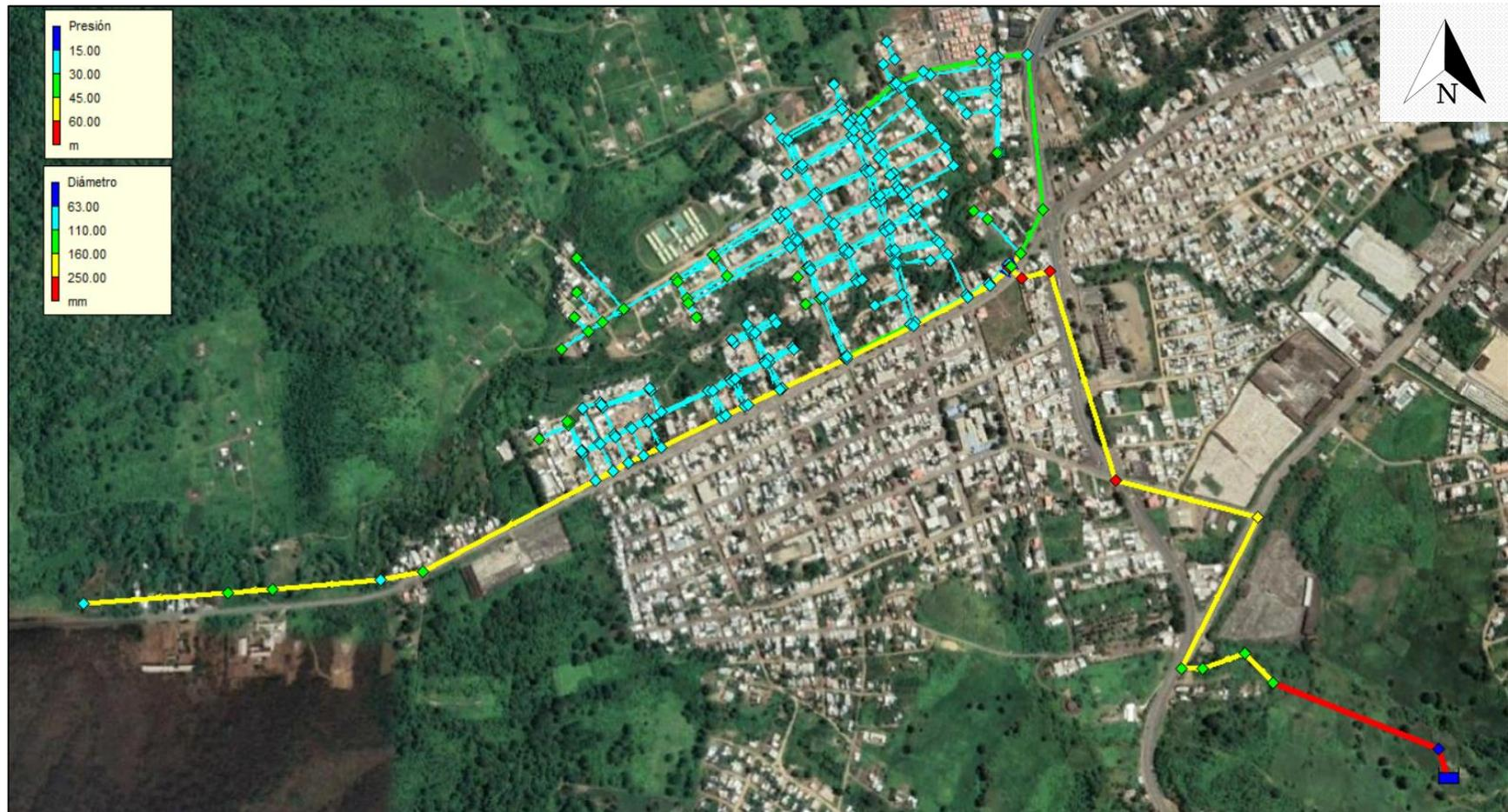
Figura 31.-Simulación con caudal máximo horario con válvula reguladora de presión (Tomado de: Autoría Propia)
