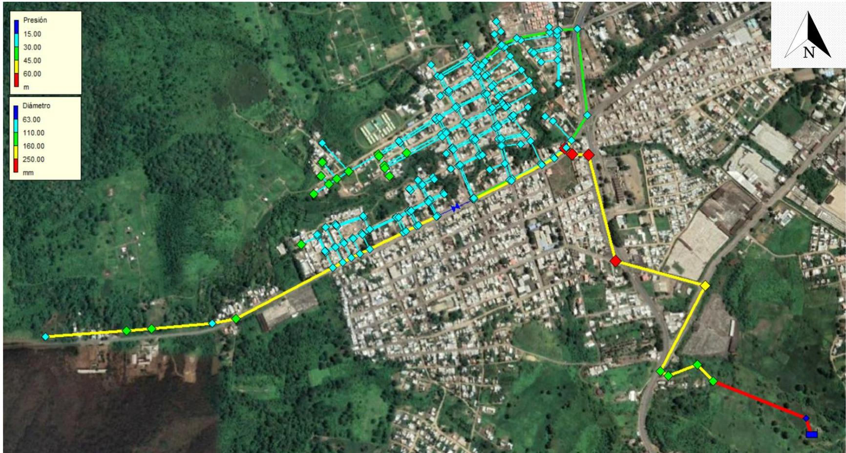
Figura 43.-Simulación del caudal promedio con válvulas reguladoras de presión (Tomado de: Autoría Propia)
