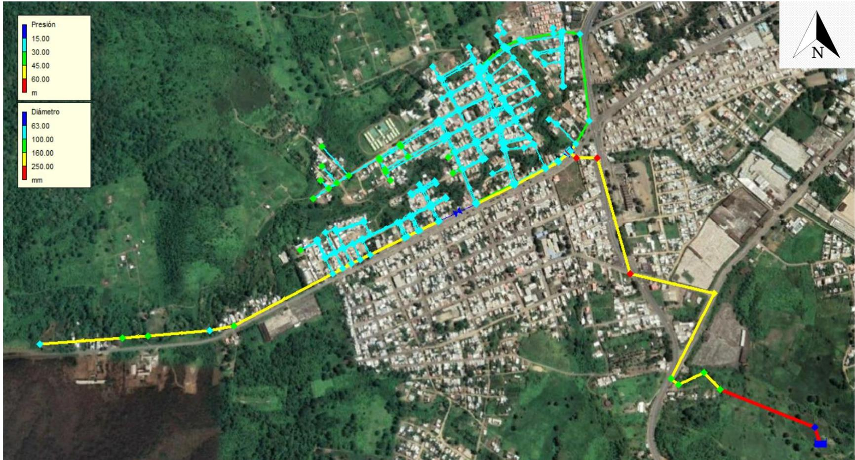
Figura 41.-Simulación del caudal mínimo nocturno con válvulas reguladoras de presión (Tomado de: Autoría Propia)
