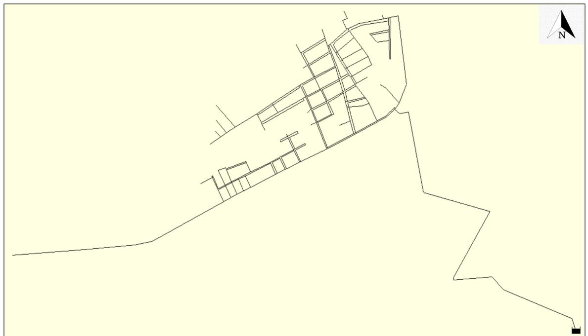
Figura 20.- Sistema de distribución implantado en Epanet. (Tomado de: Autoría Propia)
