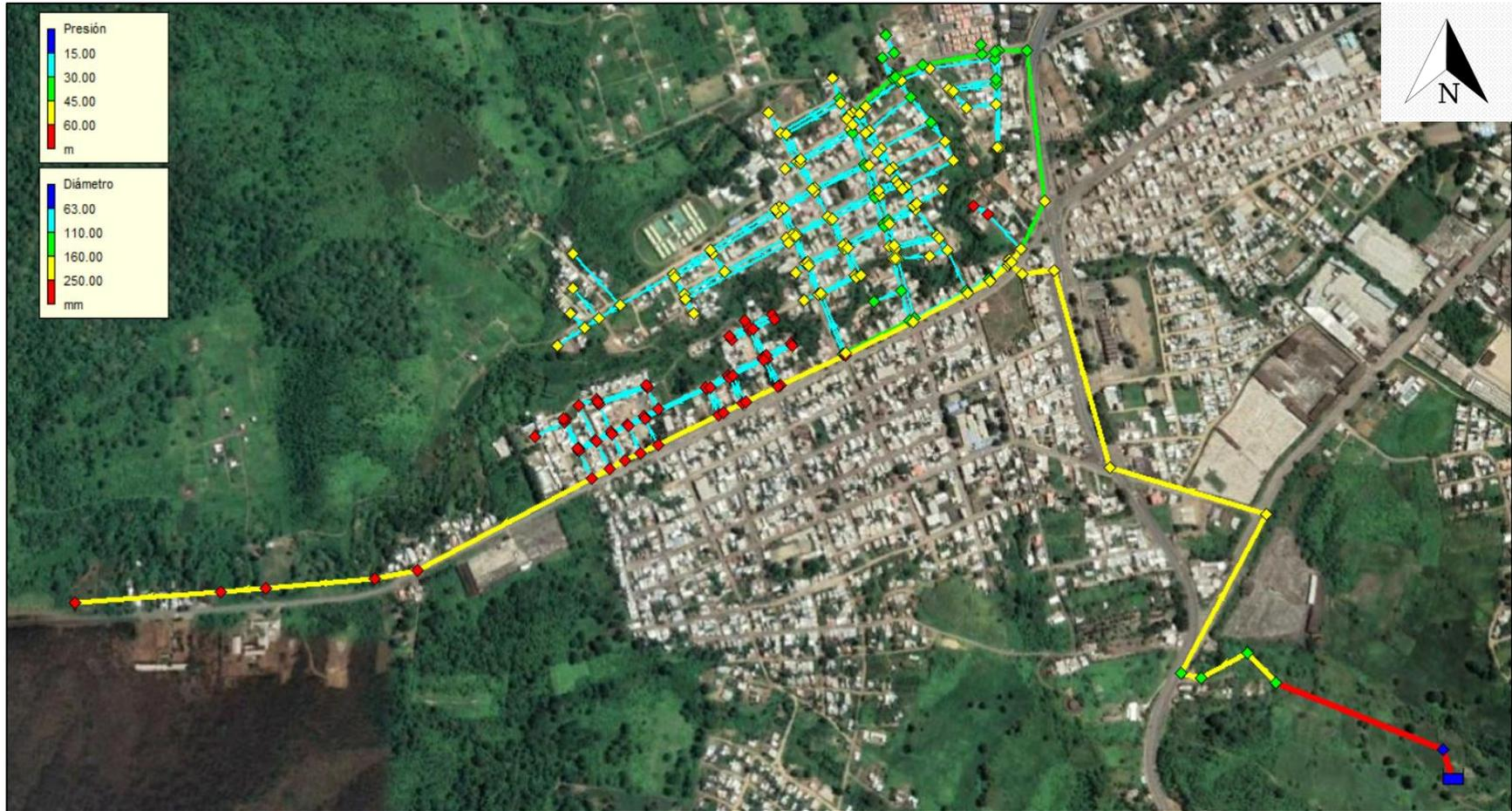
Figura 25.- Simulación con caudal máximo horario (Tomado de: Autoría Propia)
