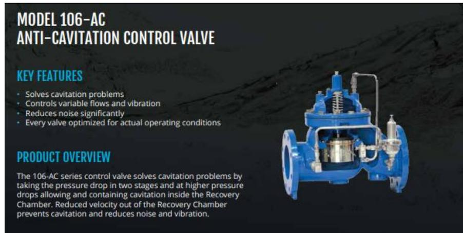
Figura 37.- Modelo 106-AC ANTI-CAVITACIÓN. (Tomado de: Singer Valve)
