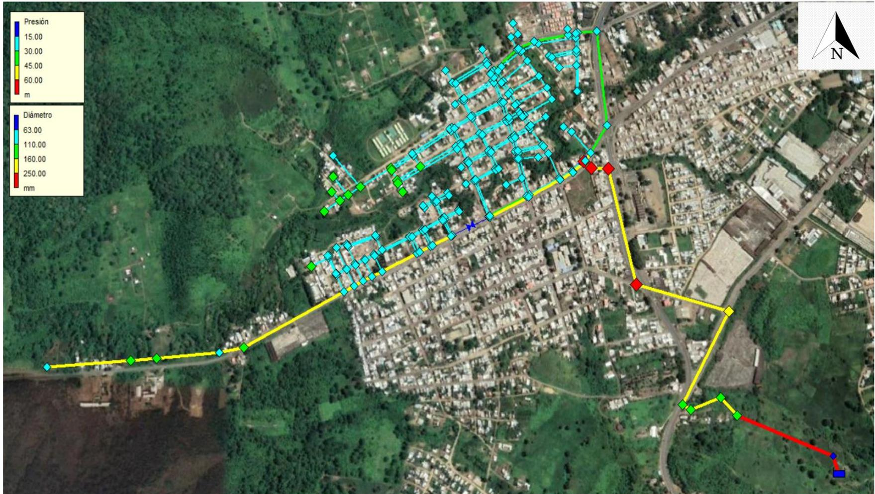
Figura 35.-Simulación con caudal promedio con válvula reguladora de presión (Tomado de: Autoría Propia)
