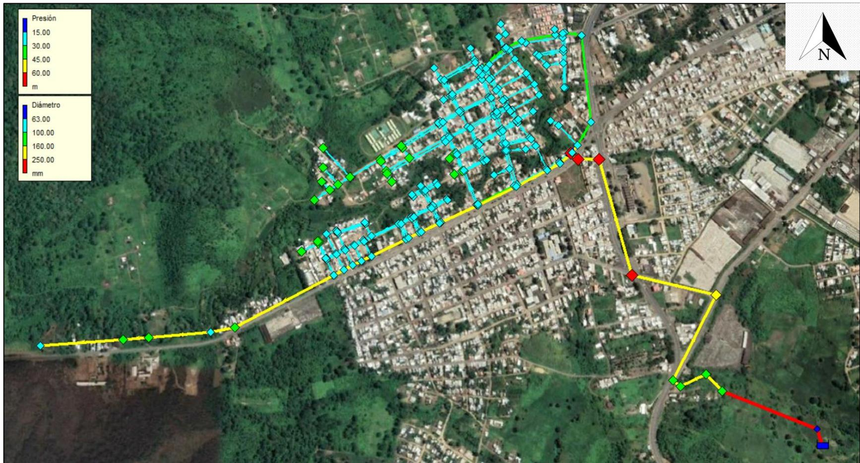
Figura 33.-Simulación con caudal mínimo nocturno con válvula reguladora de presión (Tomado de: Autoría Propia)
