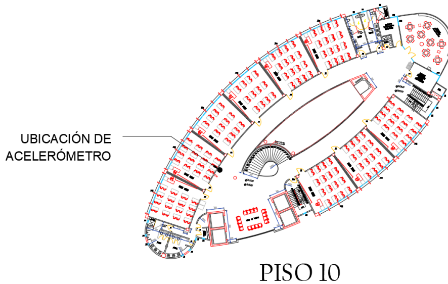
Imagen 624 Imagen del plano del décimo piso de la Facultad de Empresariales UCSG, señalando la ubicación de los ensayos para los acelerómetros. (Autoría propia)
