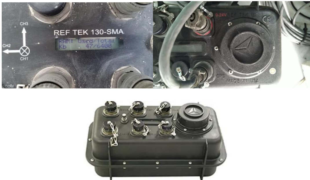
Imagen 14. Fotografías del acelerómetro modelo REF TEK 130-SMA, utilizado para el monitoreo de aceleraciones en el proyecto de titulación.
