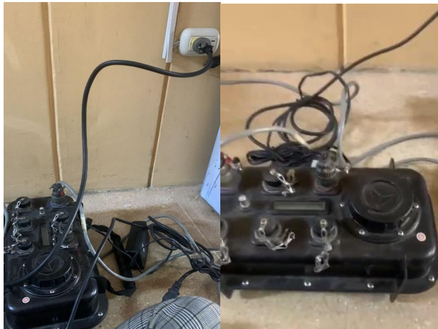
Imagen 103. Fotografías de la instalación del acelerómetro UCSG en la Facultad de Jurisprudencia.
