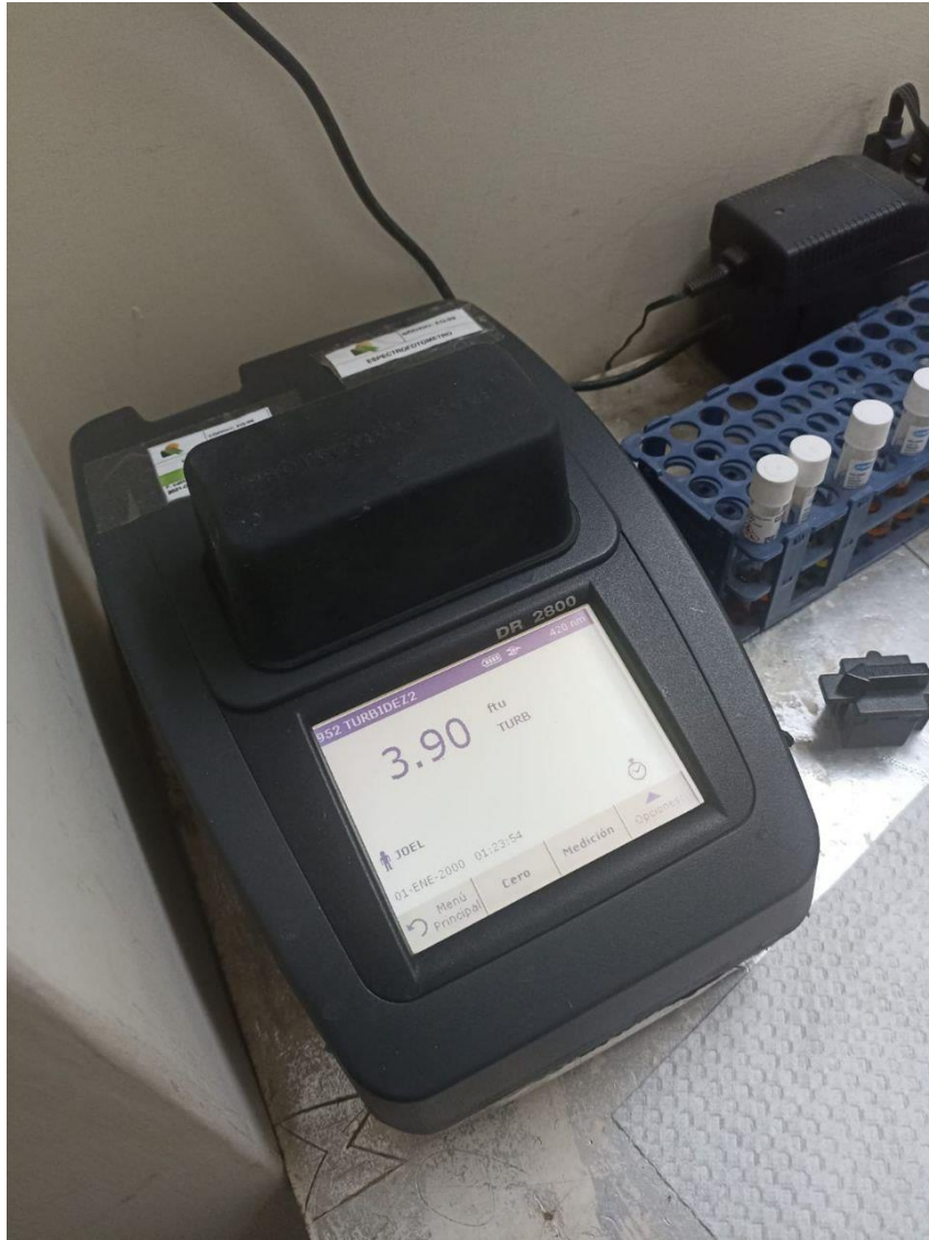
Figura 41: Medición de Turbidez muestra uno del equipo de laboratorio
