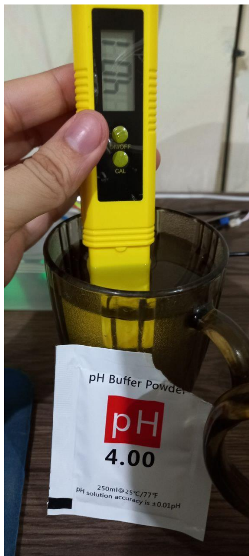
Figura 23: Medición con dispositivo comercial de solución de 4.00 pH
