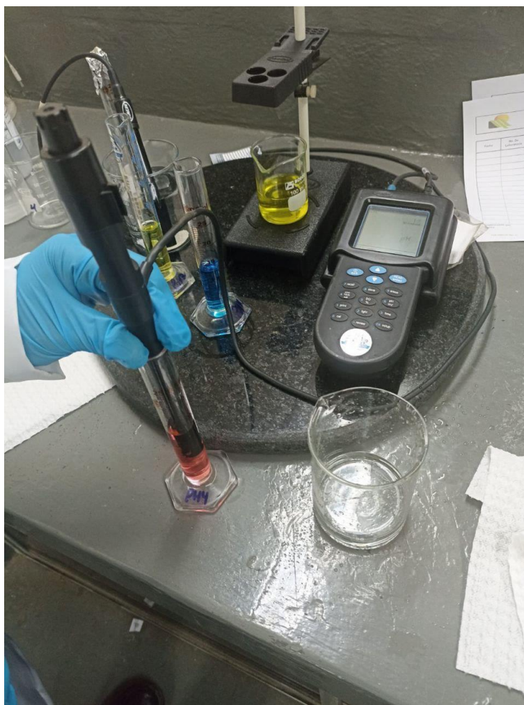
Figura 31: Calibración de instrumento de medición de pH del laboratorio
