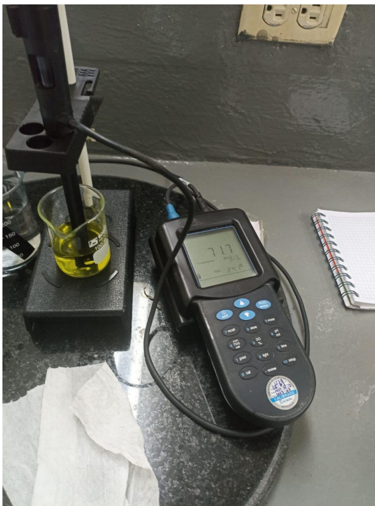
Figura 39: Medición de TDS muestra dos del equipo de laboratorio
