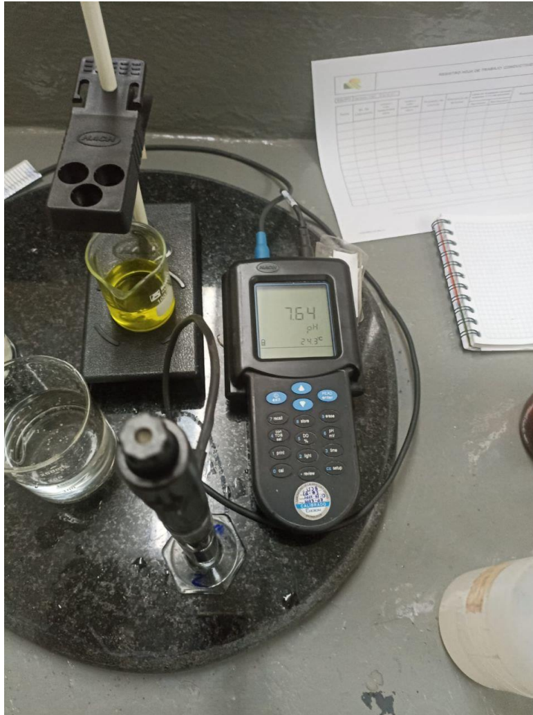
Figura 35: Medición de pH muestra dos del equipo de laboratorio
