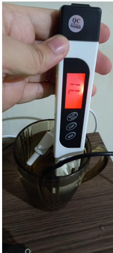
Figura 18: Medición de tds con dispositivo comercial
