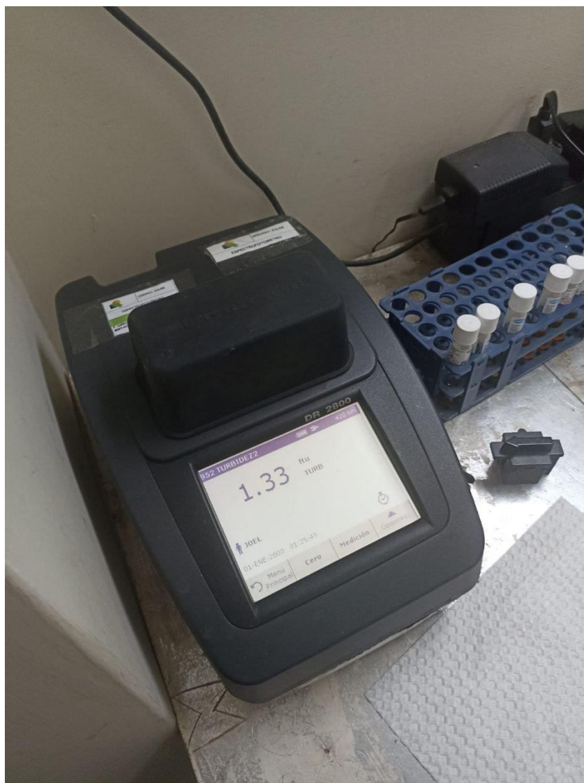
Figura 43: Medición de Turbidez muestra dos del equipo de laboratorio
