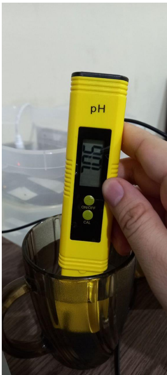
Figura 27: Medición de muestra de agua con pH desconocido del dispositivo comercial.
