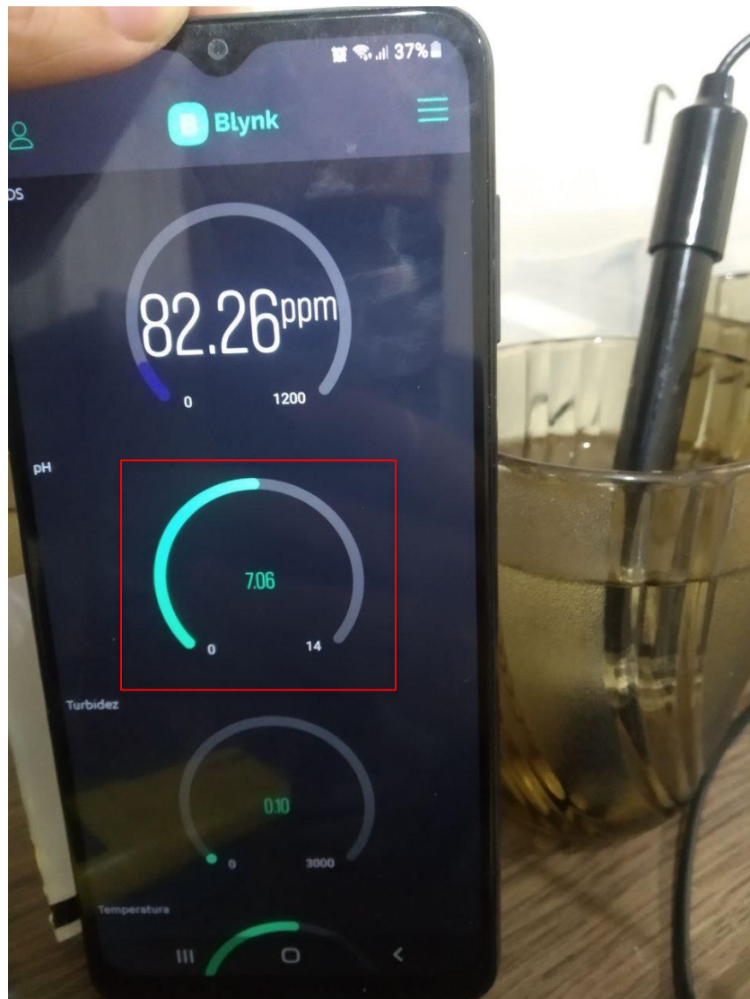
Figura 28: Medición de muestra de agua con pH desconocido por el prototipo.
