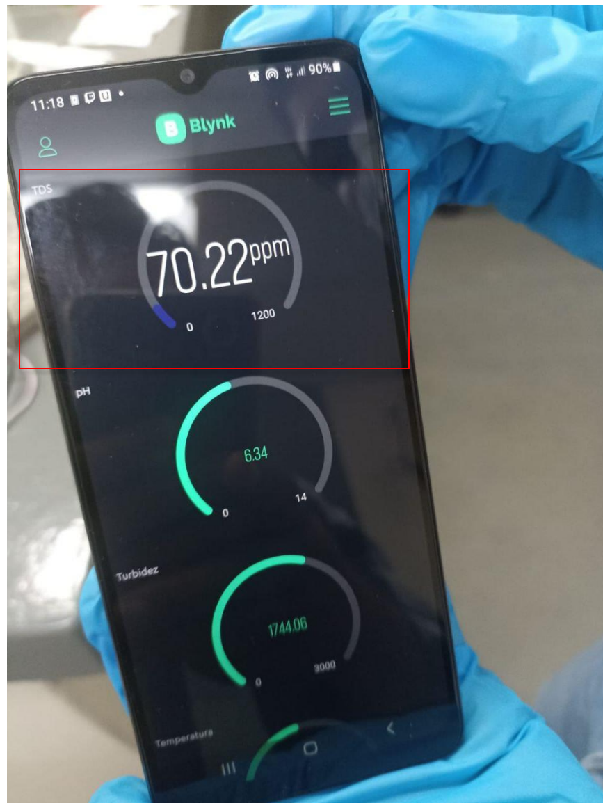
Figura 40: Medición de TDS muestra dos con prototipo
