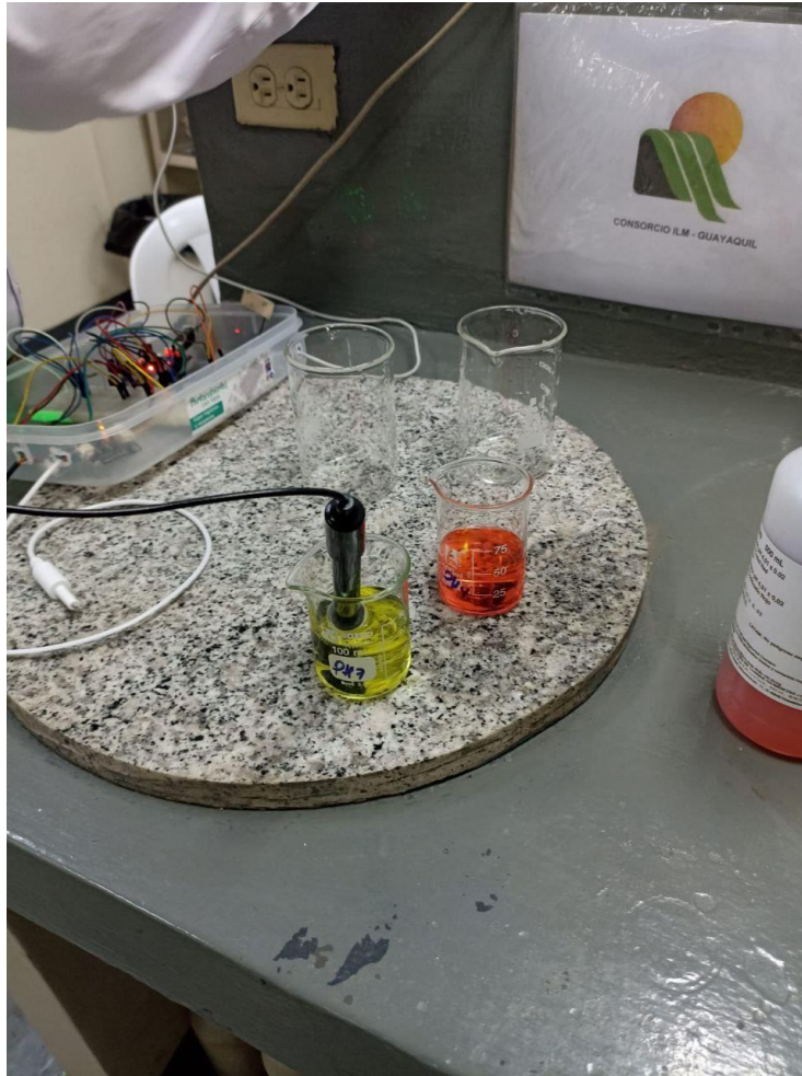
Figura 32: Calibración de sensor de pH del prototipo.
