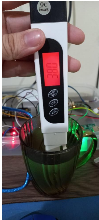
Figura 20: Medición de tds con sal en dispositivo comercial
