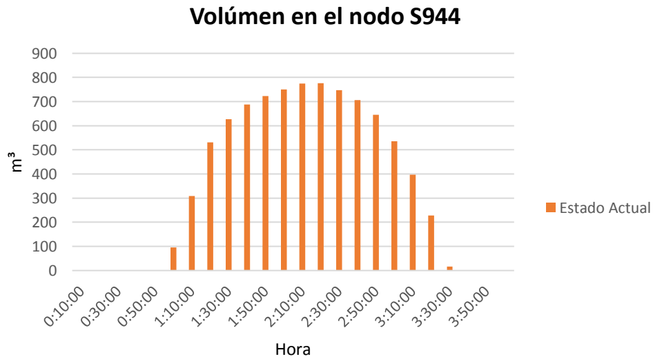
Ilustración 43. Gráfica volumen vs tiempo para el nodo S944, del escenario actual. (Bernal, 2022)
