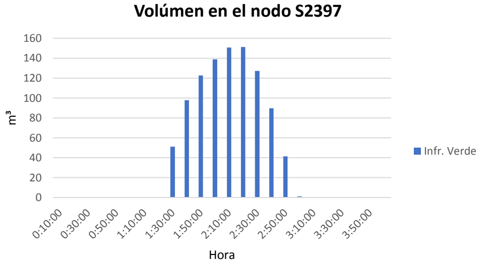
Ilustración 71. Gráfica volumen vs tiempo para el nodo S2397, con infraestructura verde. (Bernal, 2022)
