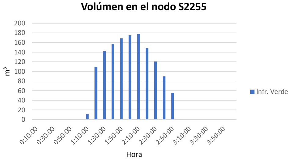
Ilustración 69. Gráfica volumen vs tiempo para el nodo S2255, con infraestructura verde. (Bernal, 2022)
