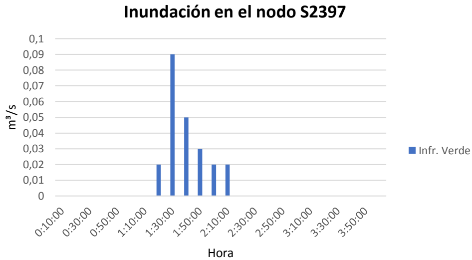
Ilustración 78. Gráfica inundación vs tiempo para el nodo S2397, con infraestructura verde. (Bernal, 2022)
