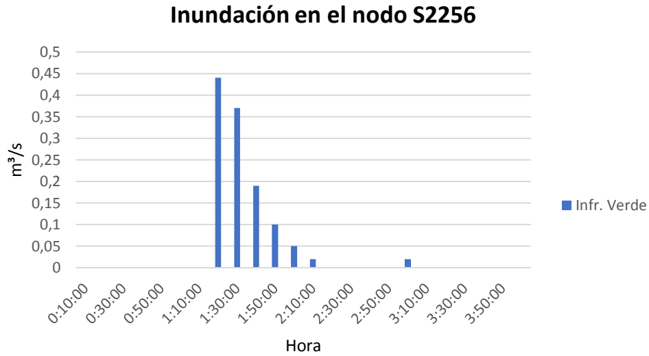
Ilustración 75. Gráfica inundación vs tiempo para el nodo S2256, con infraestructura verde. (Bernal, 2022)
