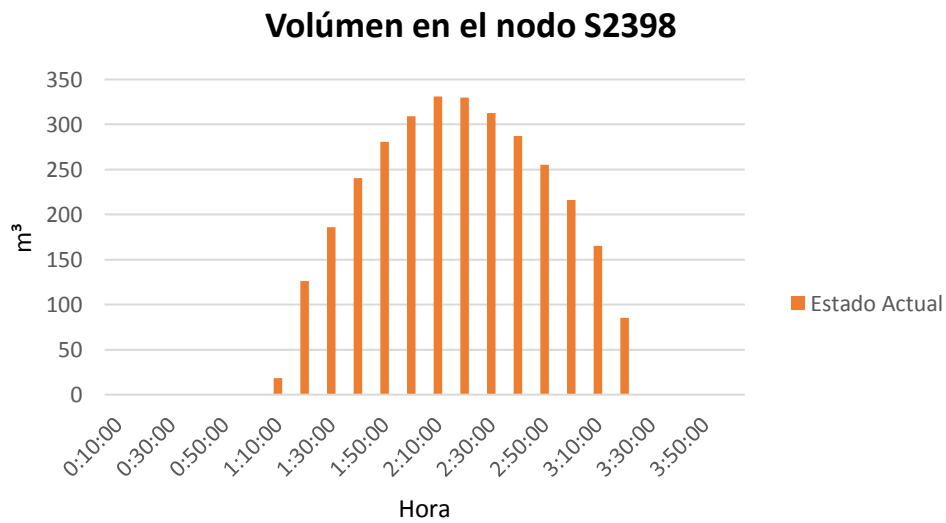
Ilustración 41. Gráfica volumen vs tiempo para el nodo S2398, del escenario actual. (Bernal, 2022)
