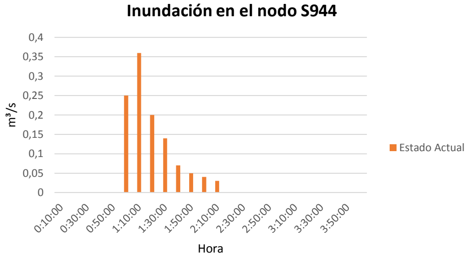
Ilustración 53. Gráfica inundación vs tiempo para el nodo S944, del escenario actual. (Bernal, 2022)
