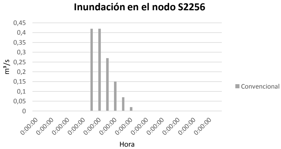
Ilustración 94. Inundación vs tiempo del nodo S2256, con solución convencional. (Bernal, 2022)
