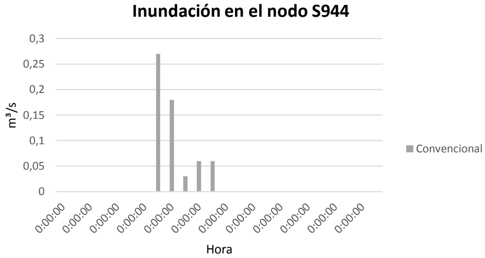
Ilustración 98. Inundación vs tiempo del nodo S944, con solución convencional. (Bernal, 2022)
