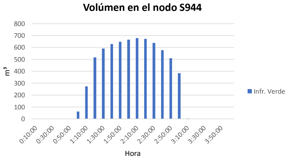
Ilustración 72. Gráfica volumen vs tiempo para el nodo S944, con infraestructura verde. (Bernal, 2022)
