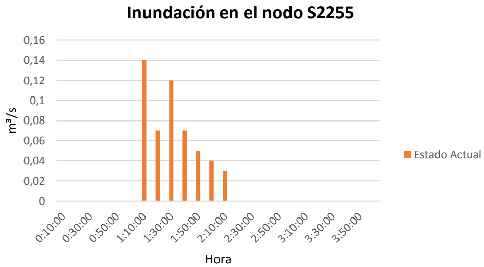
Ilustración 50. Gráfica inundación vs tiempo para el nodo S2255, del escenario actual. (Bernal, 2022)
