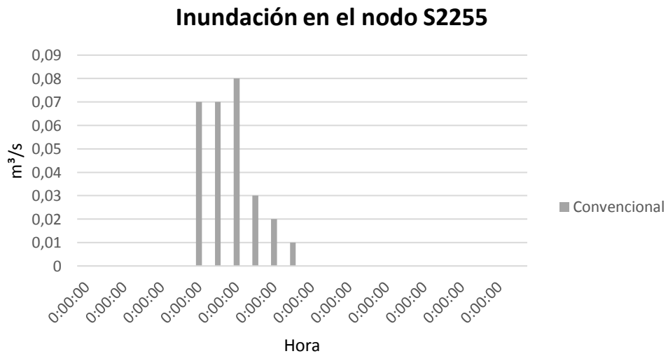
Ilustración 95. Inundación vs tiempo del nodo S2255, con solución convencional. (Bernal, 2022)
