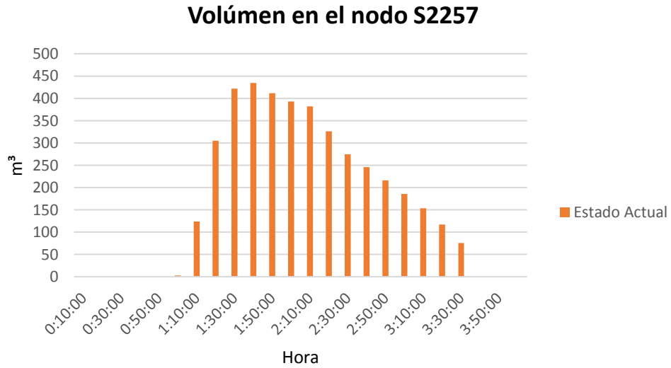
Ilustración 38. Gráfica volumen vs tiempo para el nodo S2257, del escenario actual. (Bernal, 2022)
