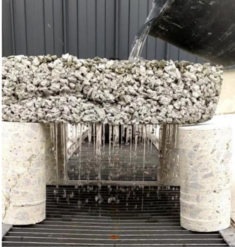
Ilustración 22. Loseta de hormigón permeable mostrando su capacidad de infiltración de agua. Obtenido de (Spalvier, Díaz, & Marrero, 2021)
