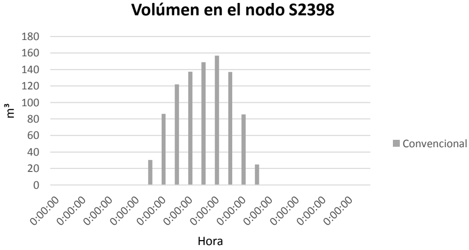
Ilustración 88. Gráfica volumen vs tiempo para el nodo S2398, con solución convencional. (Bernal, 2022)
