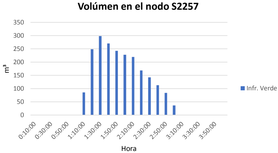
Ilustración 67. Gráfica volumen vs tiempo para el nodo S2257, con infraestructura verde. (Bernal, 2022)
