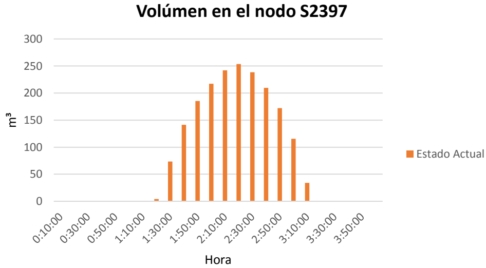
Ilustración 42. Gráfica volumen vs tiempo para el nodo S2397, del escenario actual. (Bernal, 2022)
