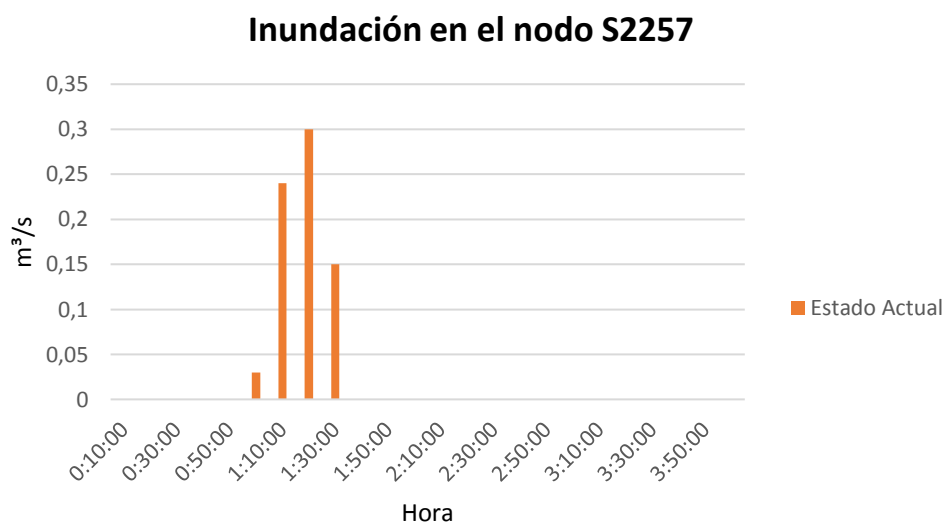
Ilustración 48. Gráfica inundación vs tiempo para el nodo S2257, del escenario actual. (Bernal, 2022)
