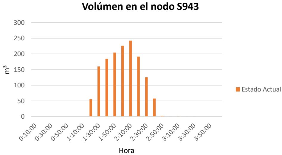
Ilustración 44. Gráfica volumen vs tiempo para el nodo S943, del escenario actual. (Bernal, 2022)
