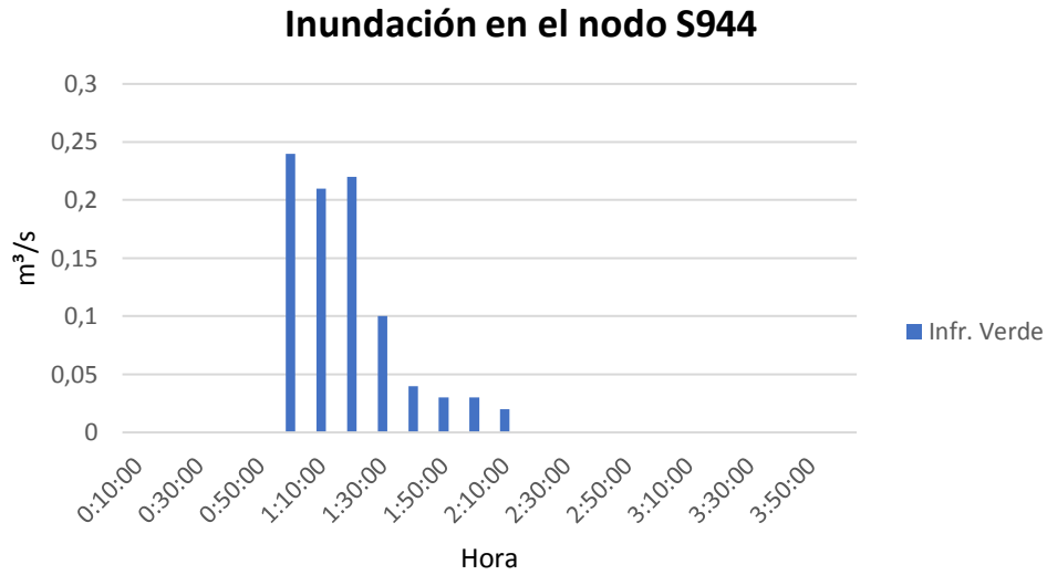
Ilustración 79. Gráfica inundación vs tiempo para el nodo S944, con infraestructura verde. (Bernal, 2022)
