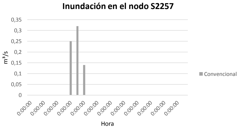
Ilustración 93. Inundación vs tiempo del nodo S2257, con solución convencional. (Bernal, 2022)
