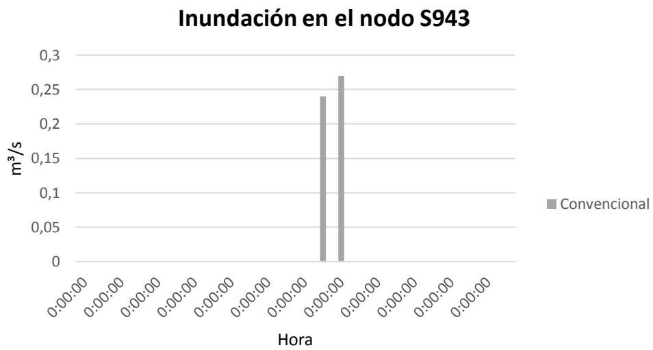
Ilustración 99. Inundación vs tiempo del nodo S943, con solución convencional. (Bernal, 2022)
