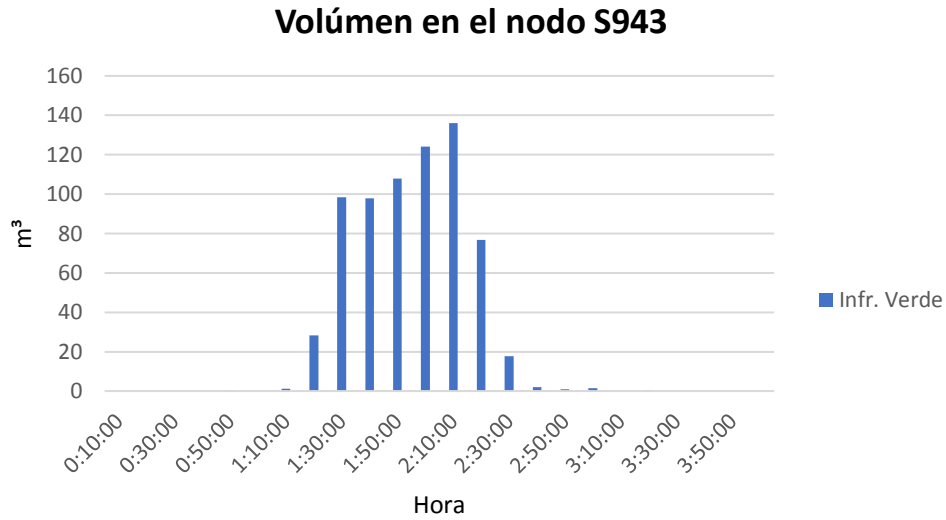
Ilustración 73. Gráfica volumen vs tiempo para el nodo S943, con infraestructura verde. (Bernal, 2022)
