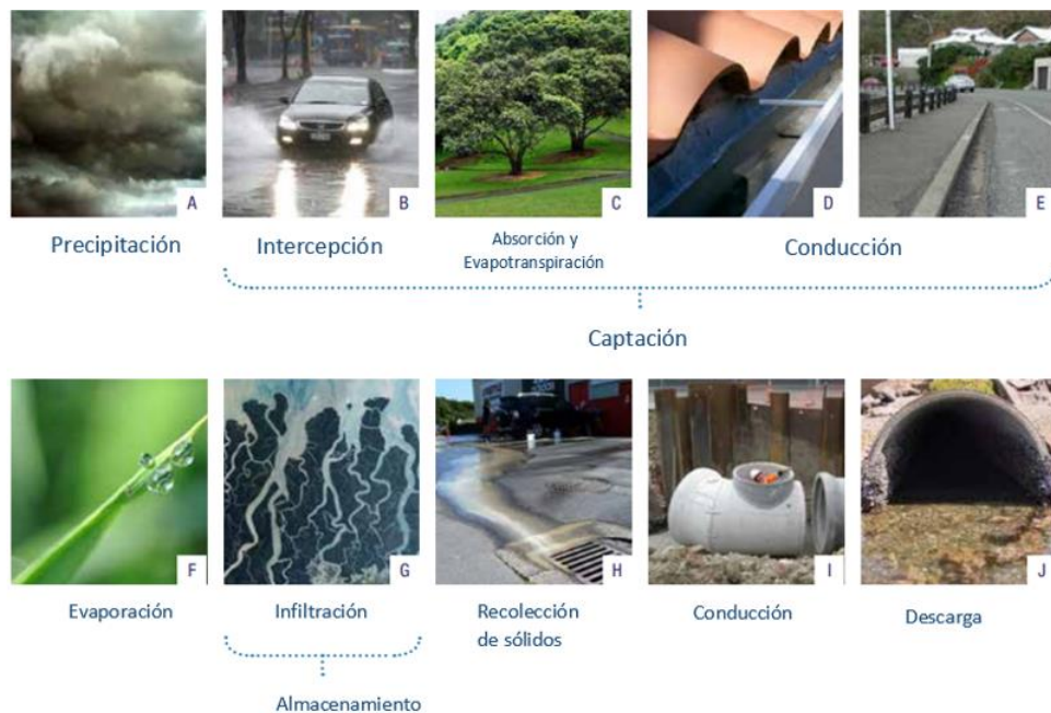
Ilustración 16. Ciclo convencional de drenaje pluvial. Obtenido de (Wellington City Council, 2013)
