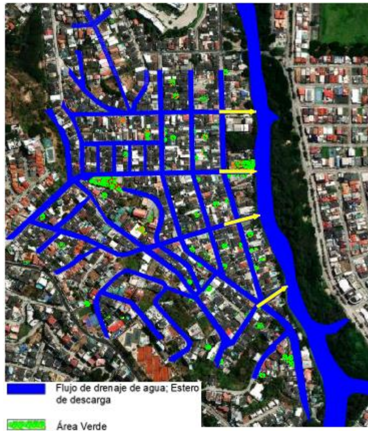
Ilustración 35. Zonas permeables y línea de flujo de agua de la ciudadela Urdesa Norte. (Bernal, 2022)
