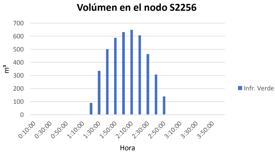
Ilustración 68. Gráfica volumen vs tiempo para el nodo S2256, con infraestructura verde. (Bernal, 2022)
