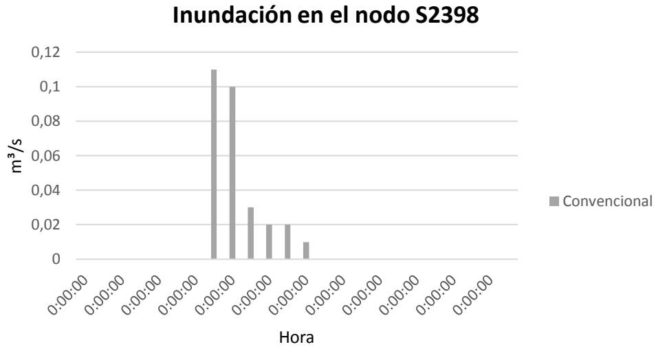
Ilustración 96. Inundación vs tiempo del nodo S2398, con solución convencional. (Bernal, 2022)
