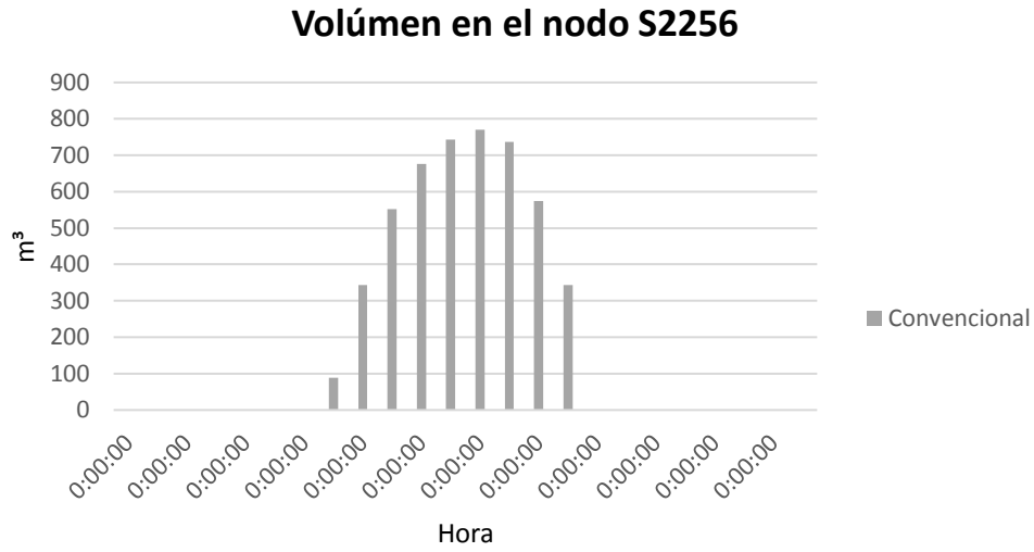
Ilustración 85. Gráfica volumen vs tiempo para el nodo S2256, con solución convencional. (Bernal, 2022)
