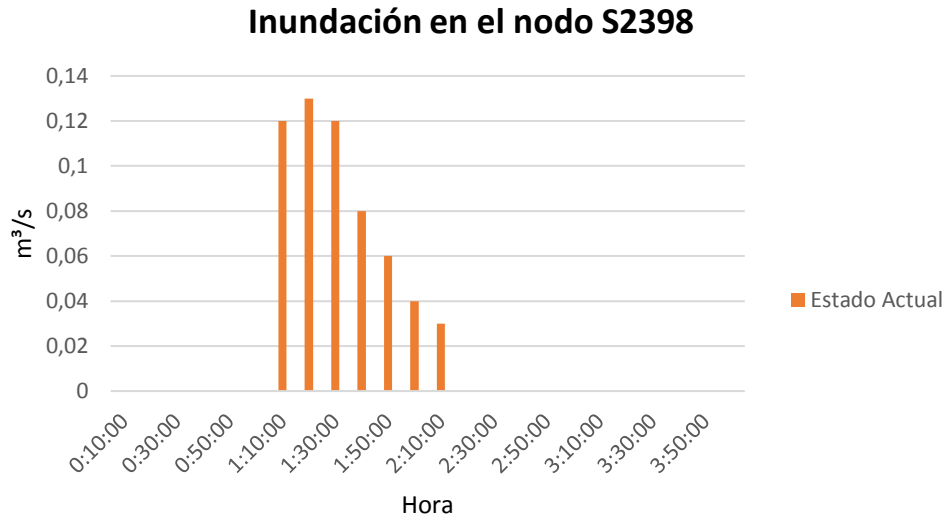
Ilustración 51. Gráfica inundación vs tiempo para el nodo S2398, del escenario actual. (Bernal, 2022)
