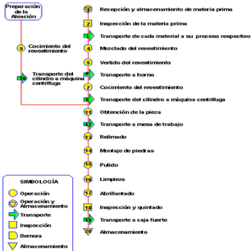
Gráfico 5.2.1 Diagrama de Flujo o de Bloques de los procesos productivos al momento de elaborar una joya
