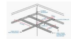
Montaje del cielo raso Gypsum tipo losa
