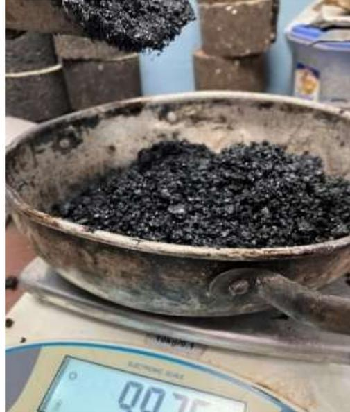
*Nota.* Peso de mezcla asfáltica caliente en balanza digital. Elaboración propia.
