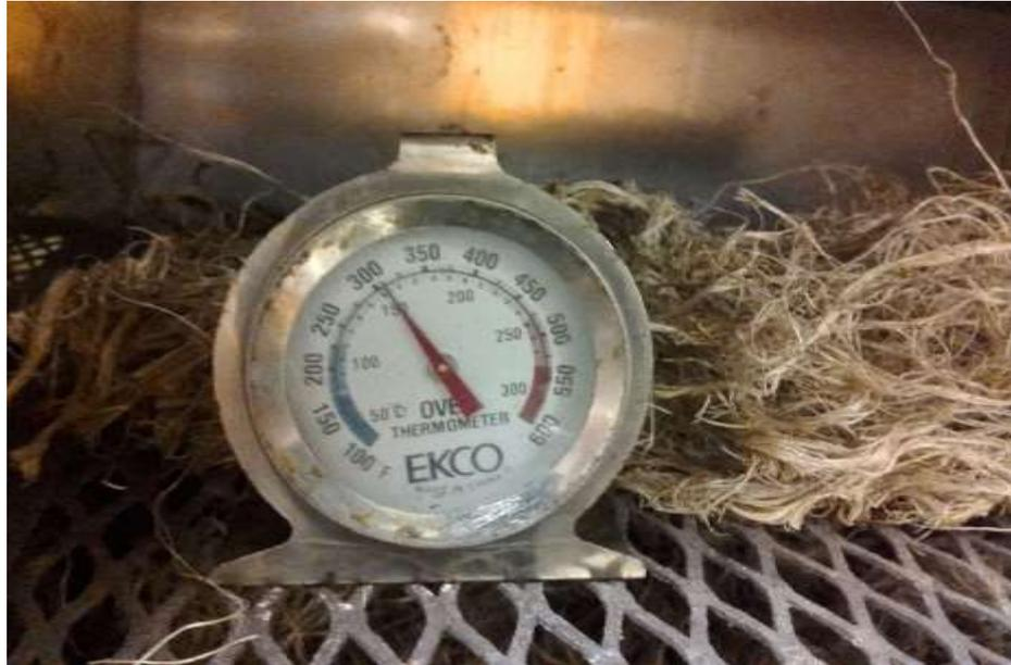
*Nota.* Al ensayar las fibras del raquis del banano a 153 °C continuaron con la misma consistencia, no hubo el efecto de calcinación. *Elaboración propia.*
