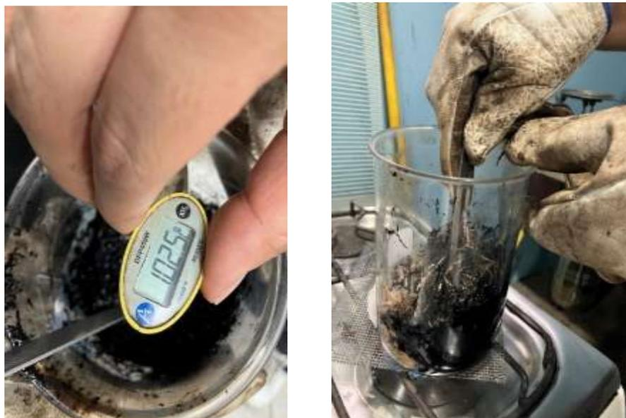
*Nota.* Figura 1. Toma de temperatura en el proceso de mezclado.
