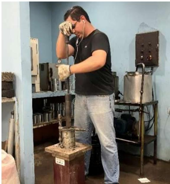
*Nota.* Al moldear las briquetas se debían realizar 75 golpes y luego invertir el cilindro para efectuar el mismo proceso. Elaboración propia.
