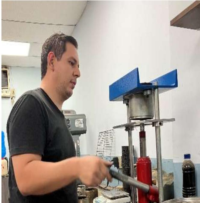
*Nota.* Se realizó el desmolde con un gato hidráulico a manivela.
