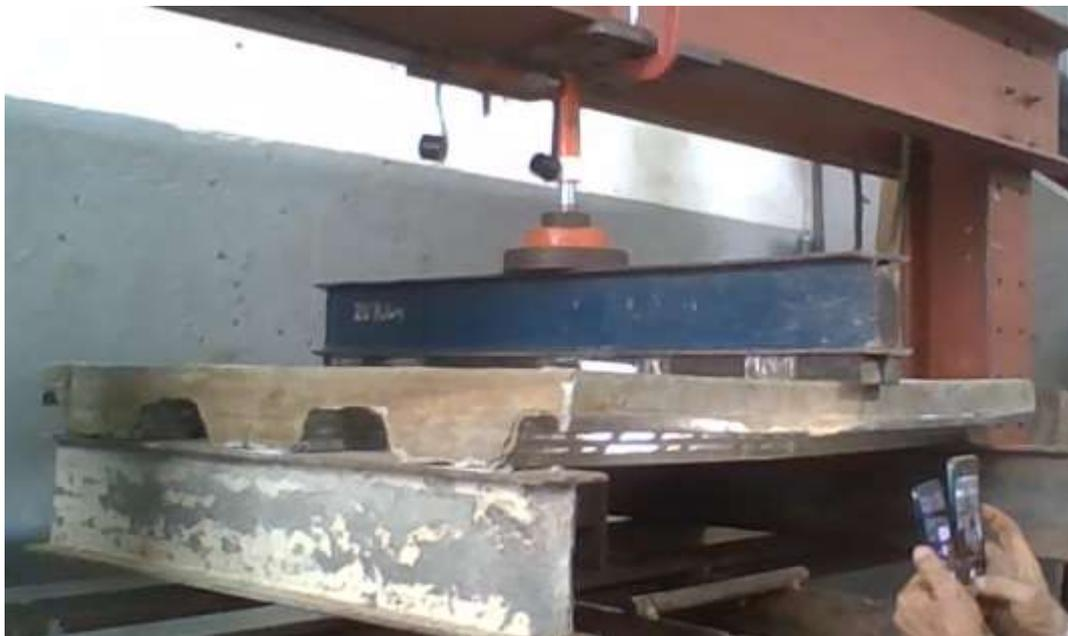
*Ilustración 38 Ensayo a flexión. Autoría Propia*
