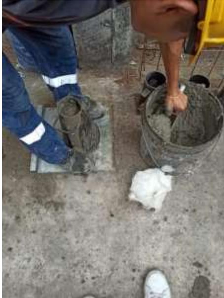
*Ilustración 23 Vertido de concreto en cono de Abrams. Autoría Propia.*
