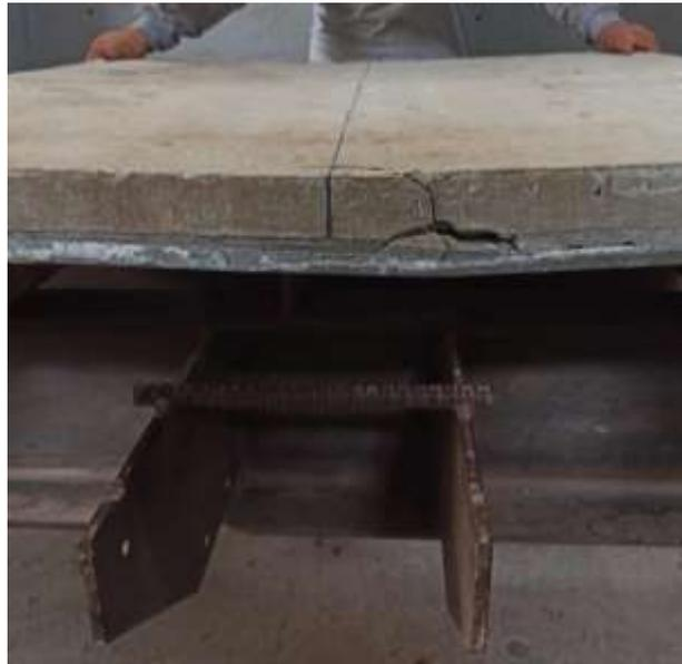
*Ilustración 39 Ruptura de losa. Autoría Propia*
