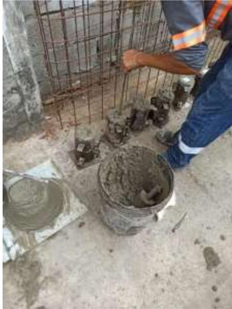
*Ilustración 22 Varillaje en los cilindros,
