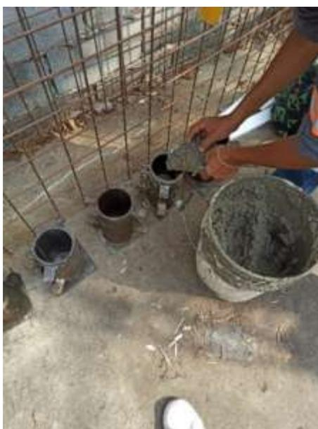
*Ilustración 21 Vertido de concreto en los cilindros, Autoría Propia.*
