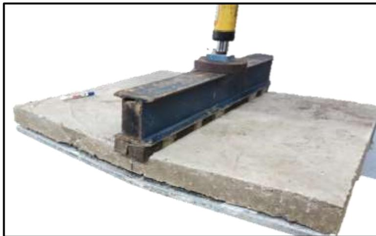
*Ilustración 30 Ensayo a flexión con gato hidráulico de 15 ton. Autoría Propia.*
