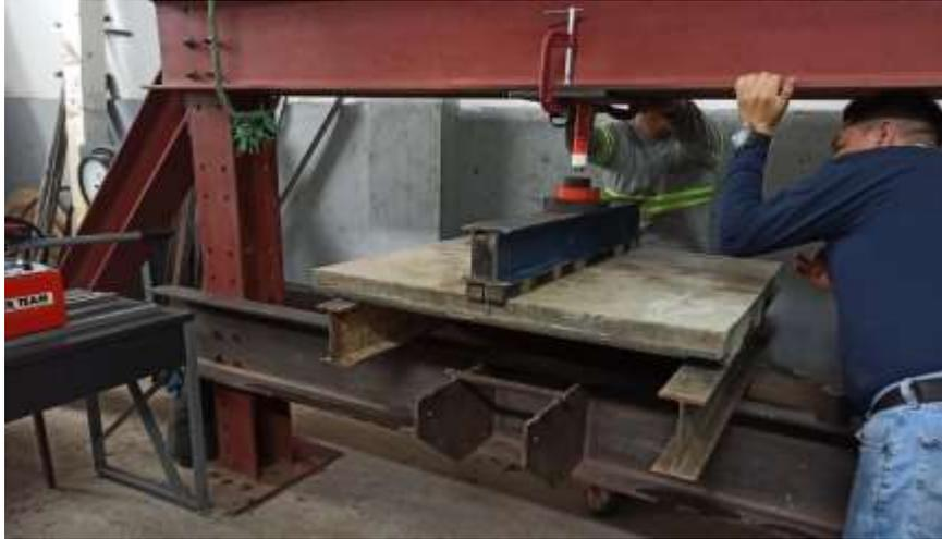
*Ilustración 29 Ensayo de flexión. Autoría Propia,*
