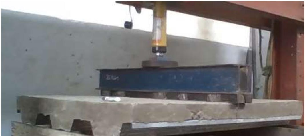
*Ilustración 46 Ensayo a flexión losa 210. Autoría Propia*
