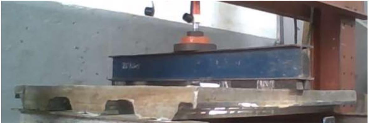
*Ilustración 37 Ensayo a flexión. Autoría Propia*
