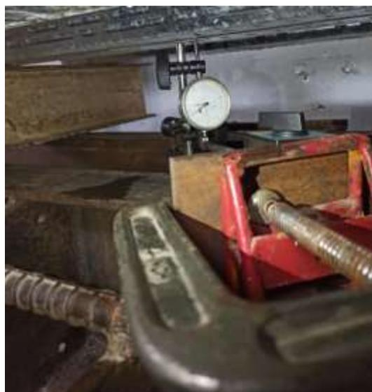
*Ilustración 32 Deformímetro mecánico. Autoría Propia.*
