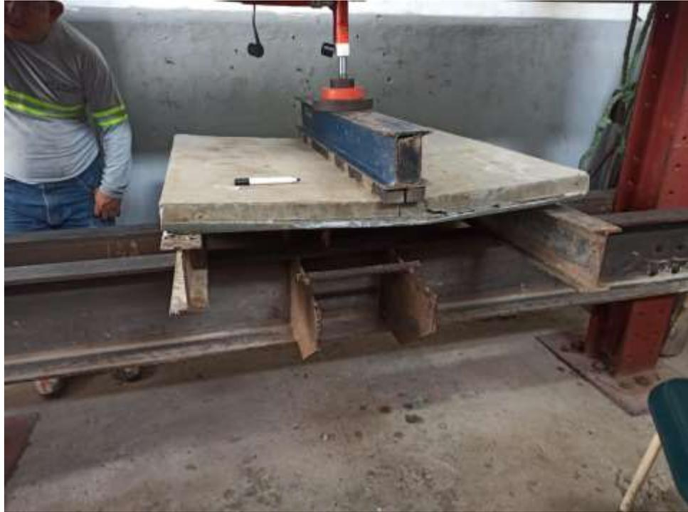
*Ilustración 31 Ensayo a flexión con gato hidráulico de 5 ton. Autoría Propia.*
