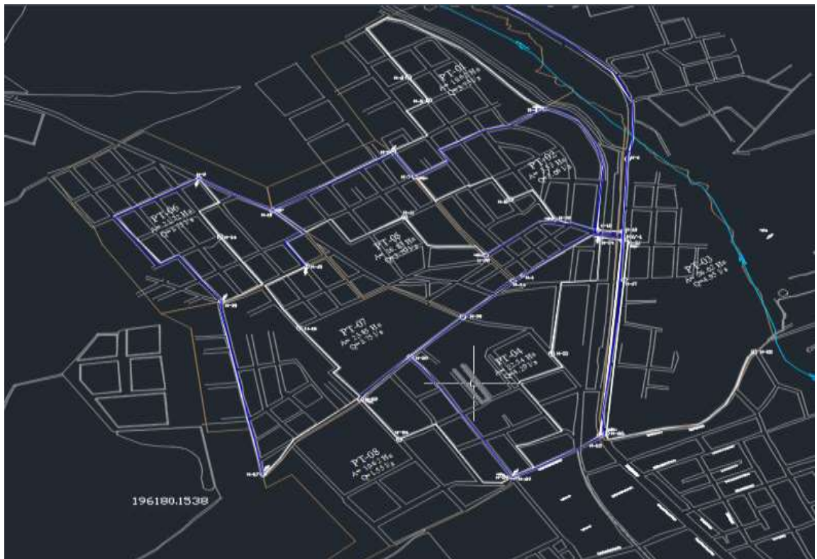
Ilustración 31 Sectorización "El Tratamiento" obtenida de AUTOCAD
